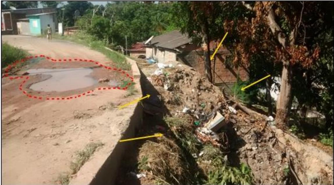
Figura 13: tracejado vermelho destacando ponto de alagamento; setas amarelas indicam a presença de entulho.
