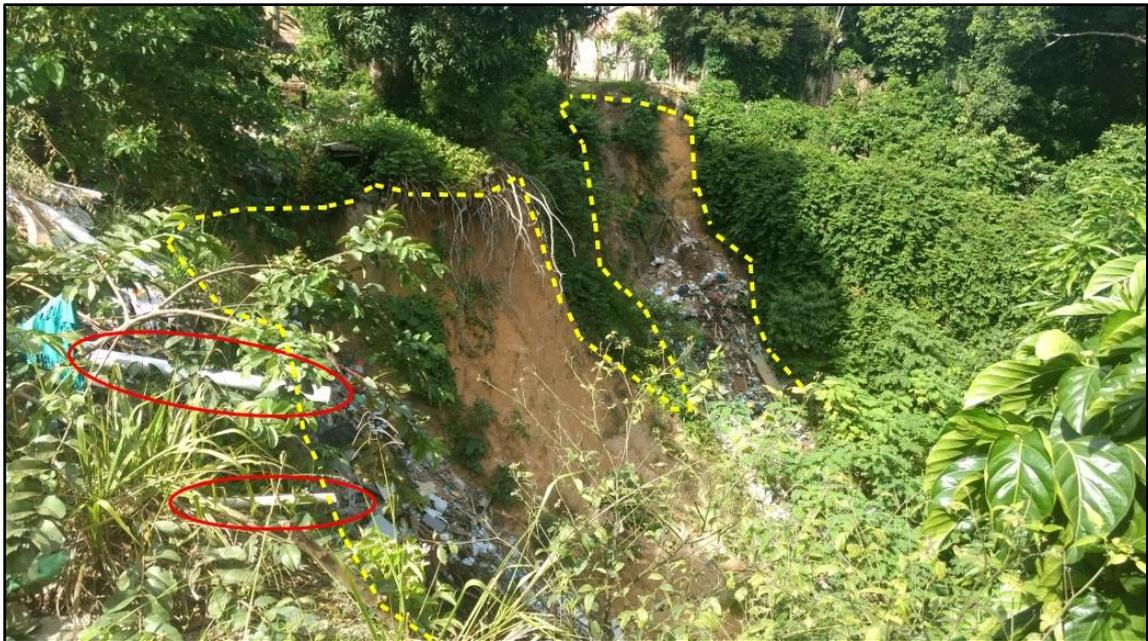
Figura 18: elipses vermelhas indicam encanamentos responsáveis pelo lançamento de efluentes domésticos. Linha tracejada amarela destaca a forma da feição erosiva.
