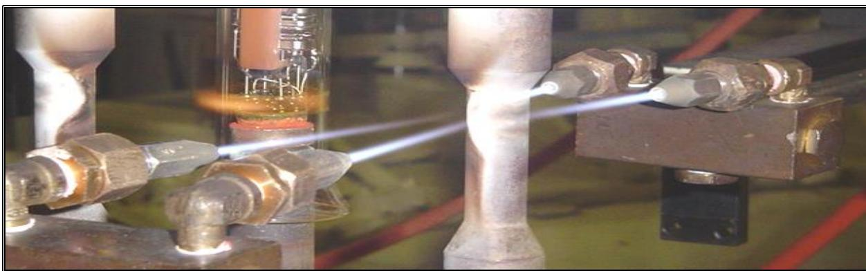
Figura 4.8 Posição de selagem do neck com o stem do canhão de elétrons.
