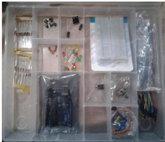
**Figura 07:** Kit Iniciante Arduino.
