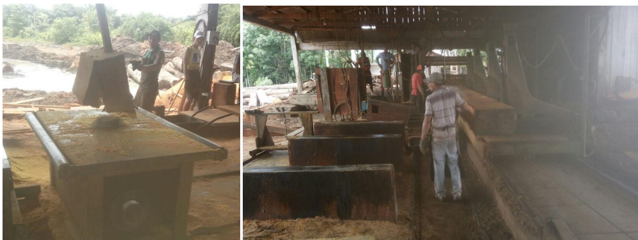
Figura 16. Disposição das máquinas e equipamentos e operador durante o desdobro da madeira.
