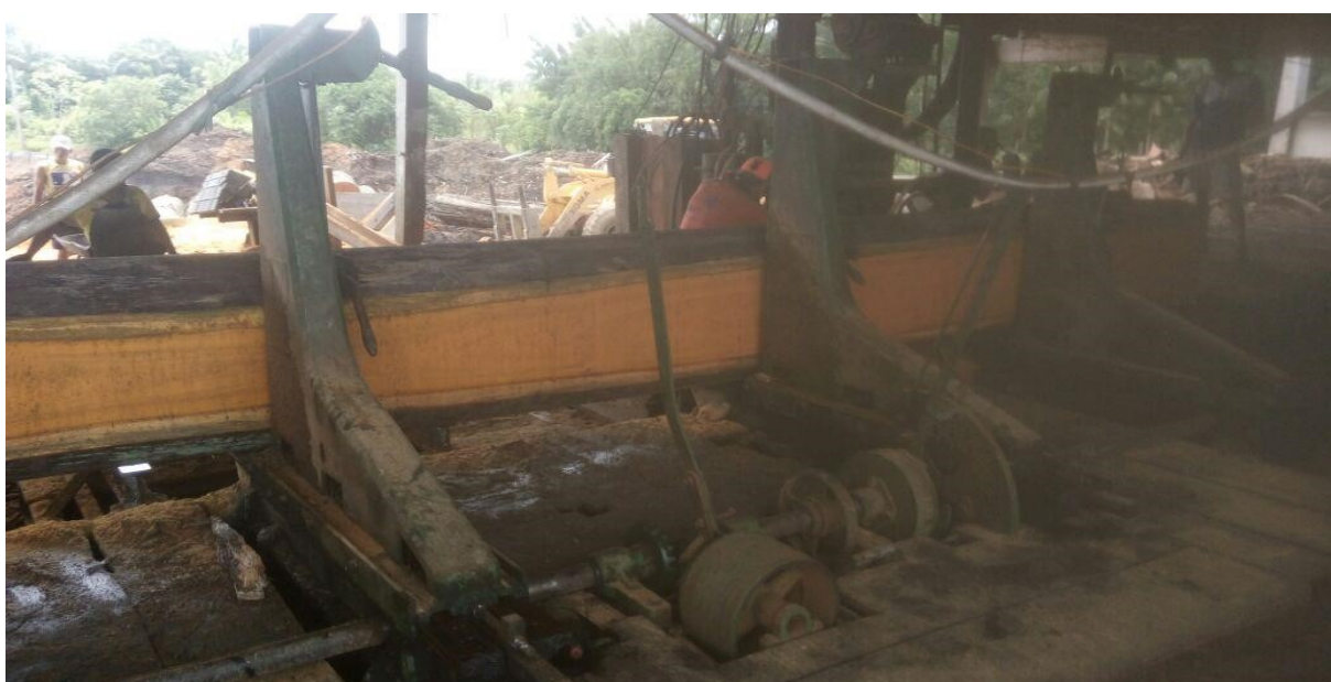
Figura 15. Madeira sendo processada na serra fita.
