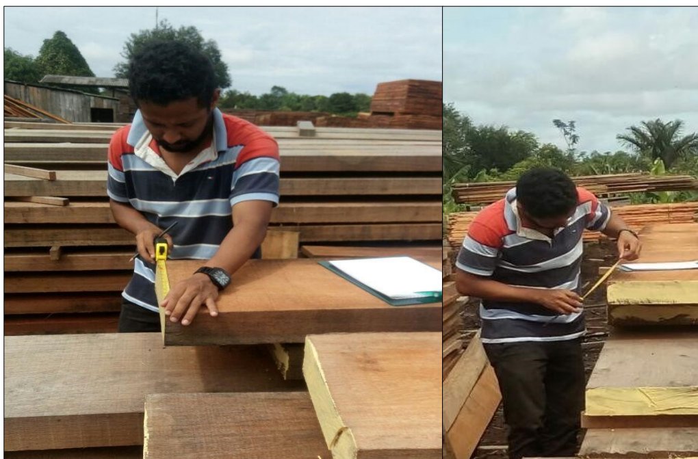
Figura 11. Medição da madeira serrada com auxílio de uma fita métrica.
