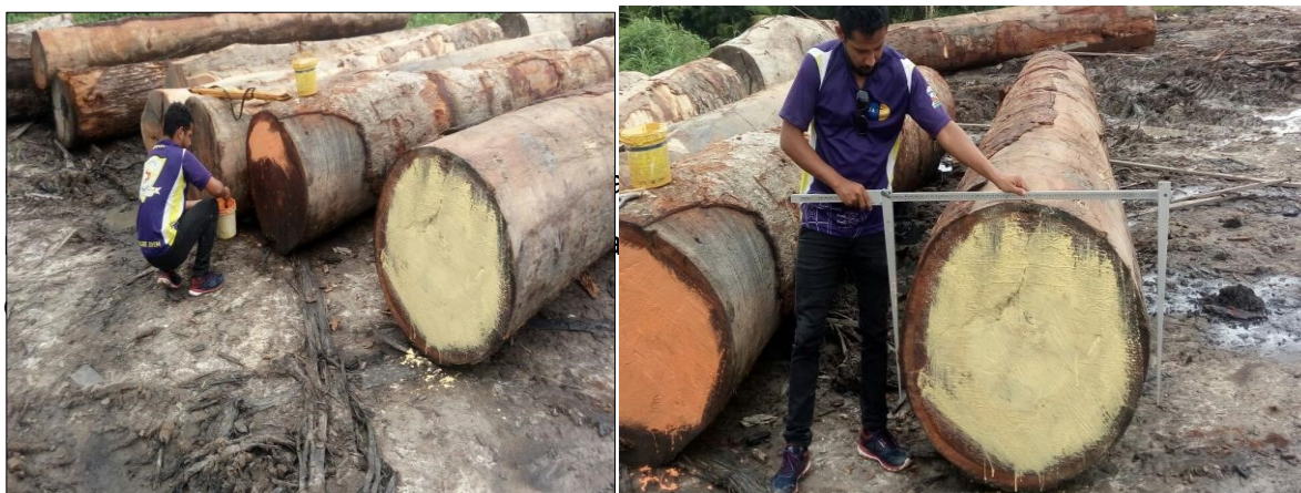
Figura 10. Pintura das faces das seções e cubagem da madeira para rastreamento das peças oriundas do desdobro.
