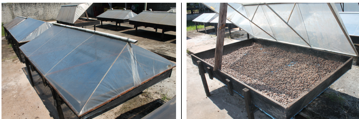
Figura 3. Estufas artesanais para a secagem das sementes de cupuaçu na agroindústria visitada.
