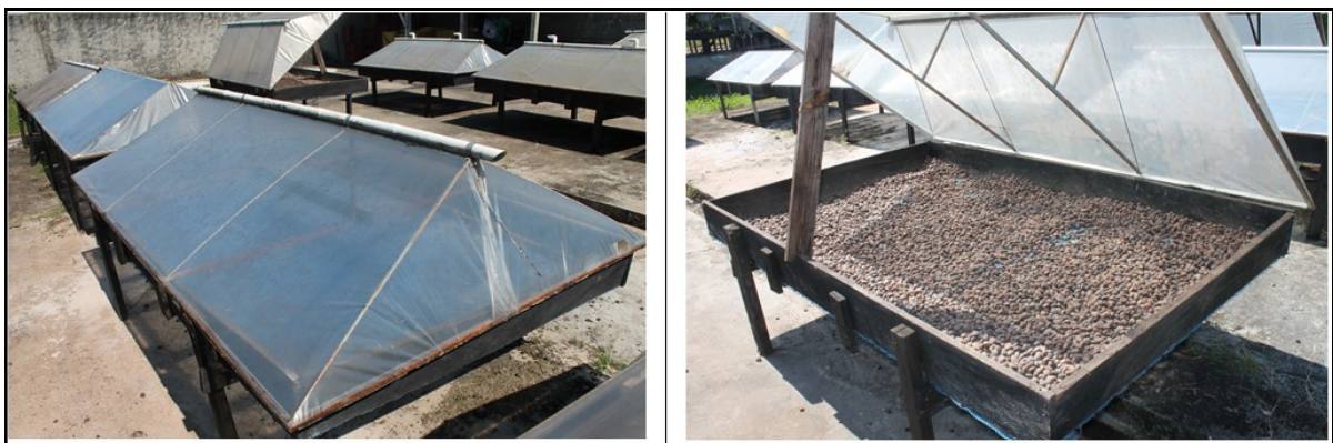
Figura 6. Estufas artesanais para a secagem das sementes de cupuaçu na agroindústria visitada.
