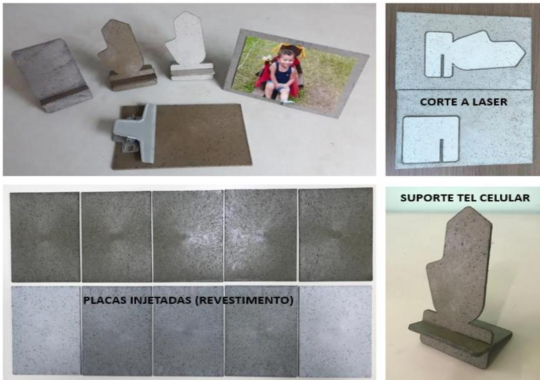
Figura 7.2 – Placas injetadas produzidas industrialmente neste trabalho e produtos potenciais
