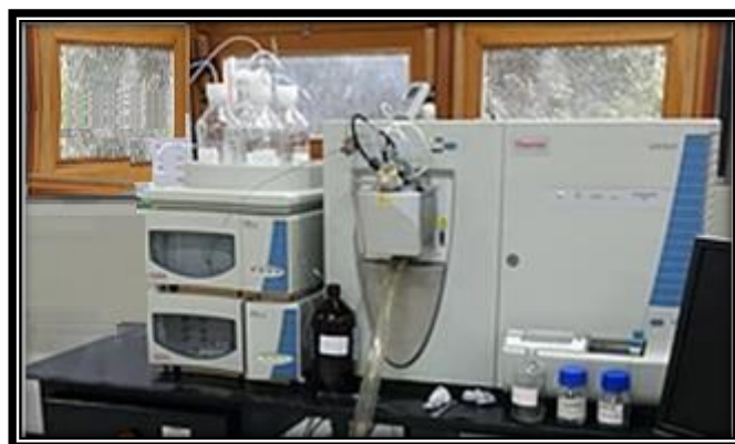
Figura 3 - Espectrômetro de massas tipo íon-trap, modelo LCQ Fleet, marca: Thermo Scientific. Fonte: Rebello, L.S.S., 2017.
