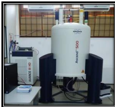
Figura 4 – Espectrômetro de Ressonância Magnética Nuclear marca: BRUKER, modelo AVANCE III HD. Fonte Rebello, L.S.S., 2017.
