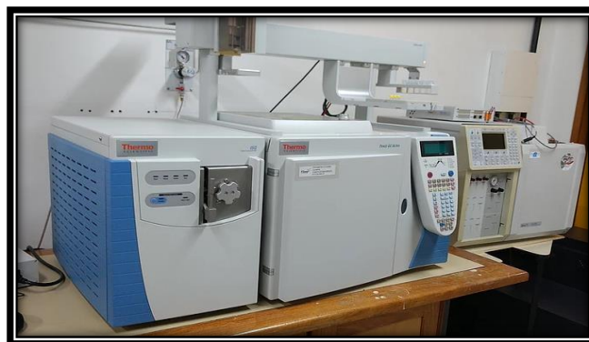
Figura 5 - Equipamento de cromatografia gasosa (Thermo Scientific), modelo: Trace CG Ultra associado ao espectrômetro de massas (Thermo Scientific), modelo: DSQIII.
