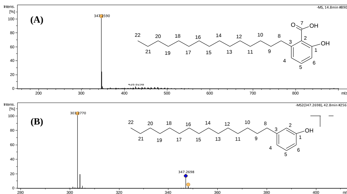
Figura 21 –Espectro de Massas (LC-MS), ácido anacárdico m/z : 347, 2590 [M-H]^- . (A) MS: 347, 2590; (B) MS^2 : 347,2590 \rightarrow 303,2770.
