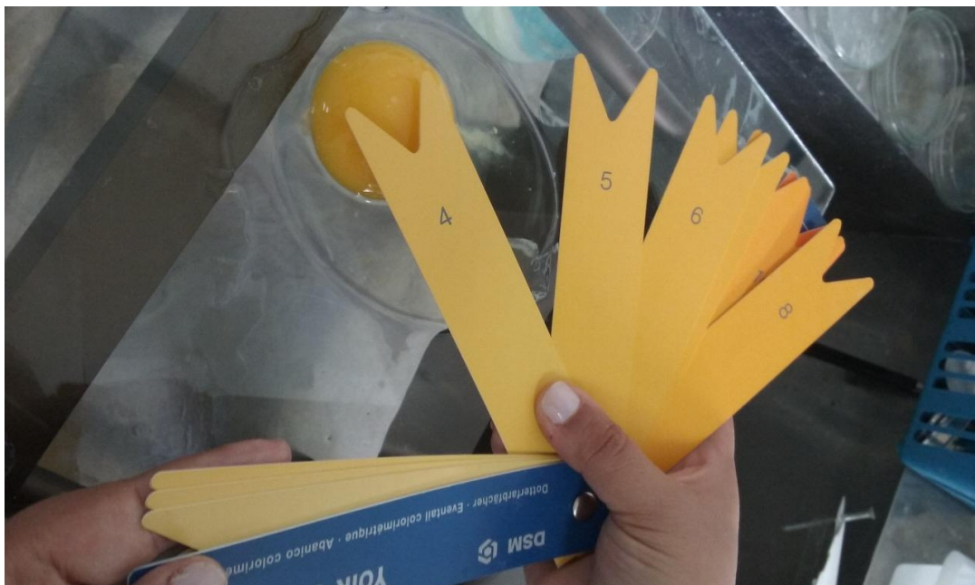
Figura 6. Análise de coloração da gema utilizando leque colorimétrico DSM® Fonte: Arquivo pessoal de Daniel Grijó Cavalcante
