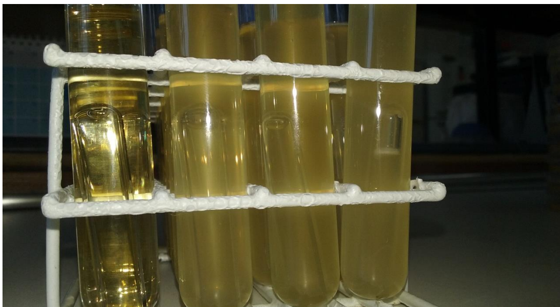
Figura 10. Tubos de ensaio contendo Caldo Lauril Sulfato de Sódio com a presença de tubos de Durham invertidos
