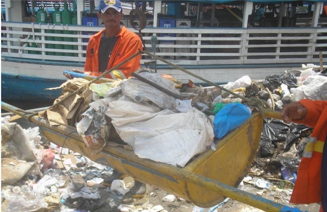
**Figura 45:** Pesagem da padiola com resíduos de montante acumulado na balsa, para pesagem e formação de amostra para análise semigravimétrica (30/11/2016)
