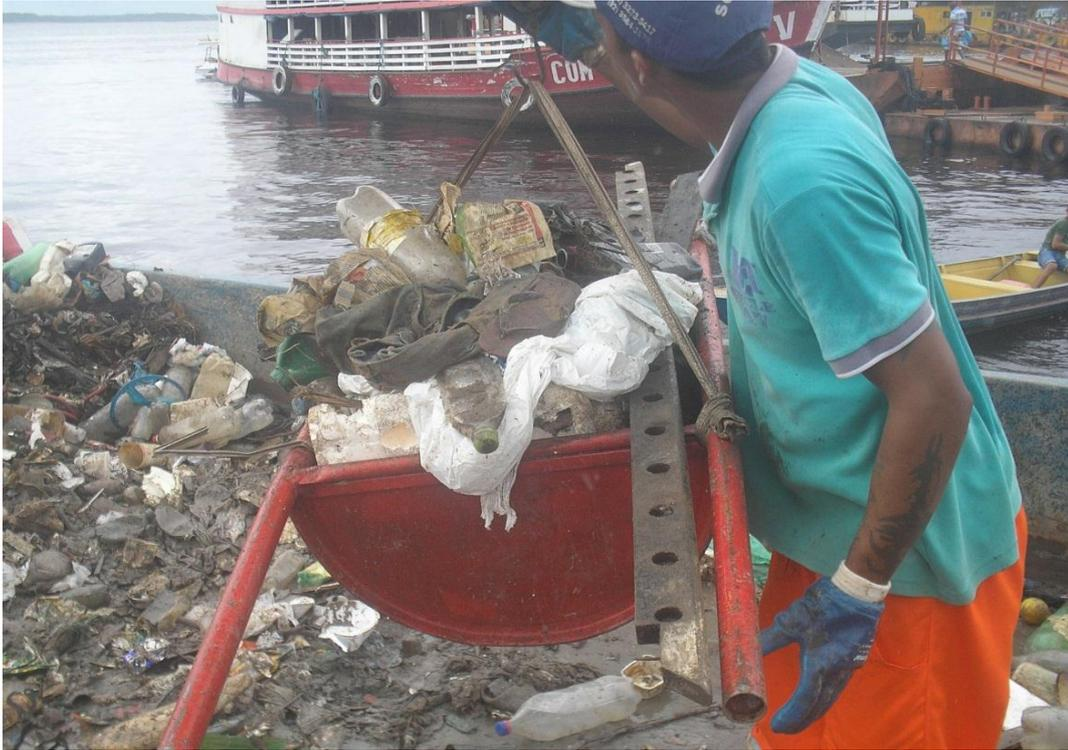
**Figura 62:** Pesagem da padiola – 3.a – com resíduos retirados de montante acumulado na balsa para pesagem e formação da amostra para análise semigravimétrica (17/12/2016)
