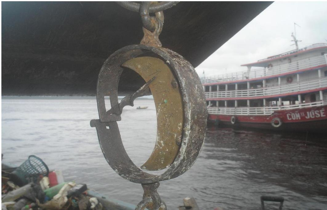
**Figura 63:** Detalhe da pesagem da padiola – 3.a – com resíduos retirados de montante acumulado na balsa, para formação da amostra para análise semigravimétrica (17/12/2016)
