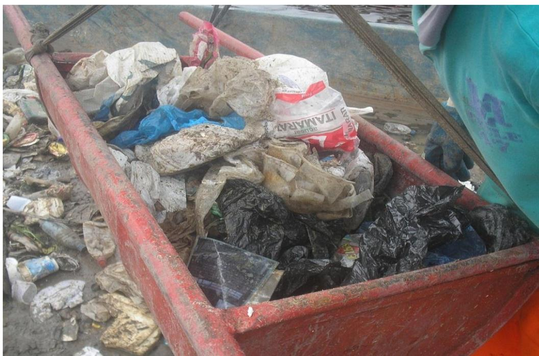
**Figura 64:** Pesagem de resíduos de plásticos moles separados da amostra formada para a análise semigravimétrica (17/12/2016)
