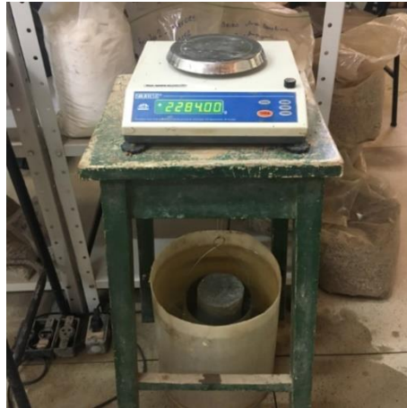
Figura 32 - Determinação da massa do corpo-de-prova em balança hidrostática após banho-maria
