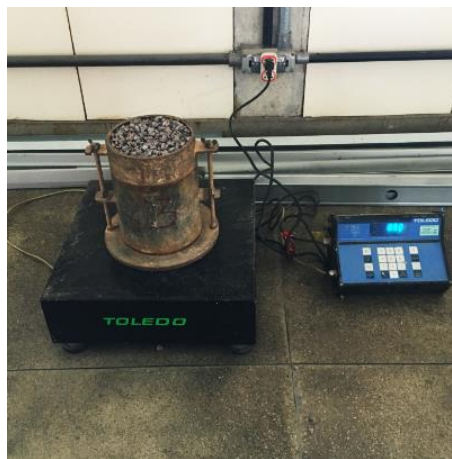
Figura 10 - Determinação da melhor proporção entre os agregados
