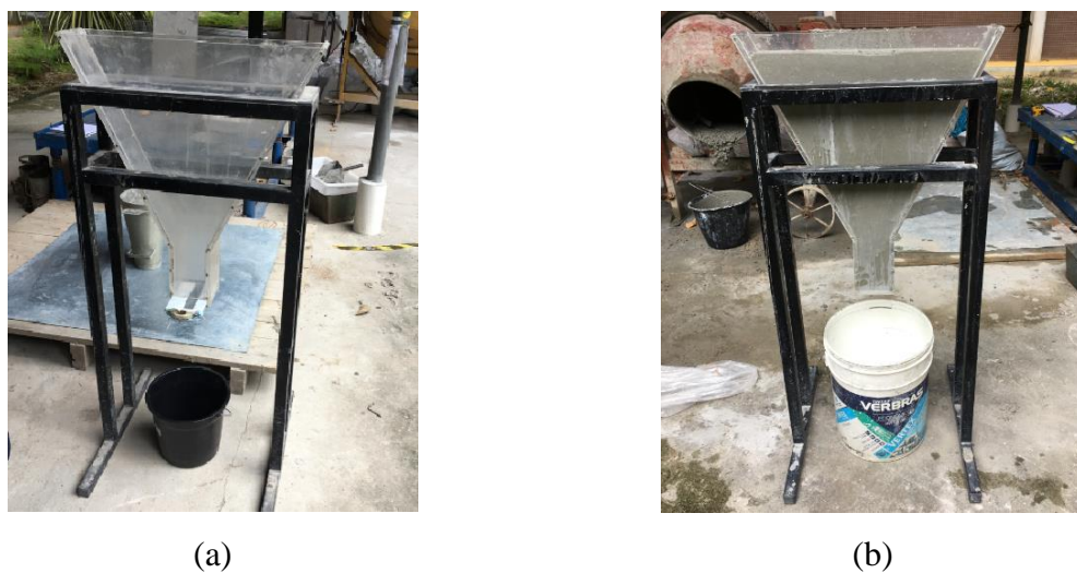
Figura 26 - Método do Funil V: a) Aparato antes do ensaio; b) Aparato sendo preenchido.
