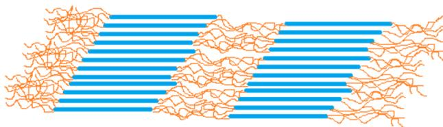
**Figura 4.5** - Representação das regiões cristalinas na cor (azul) e não cristalinas na cor (vermelha) da celulose.
