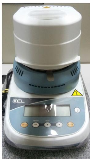
**Figura 3.1** - Analizador de umidade i-Thermo 163L
