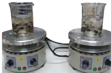
Figura 3.3 - Sistema para determinação de teor à frio
