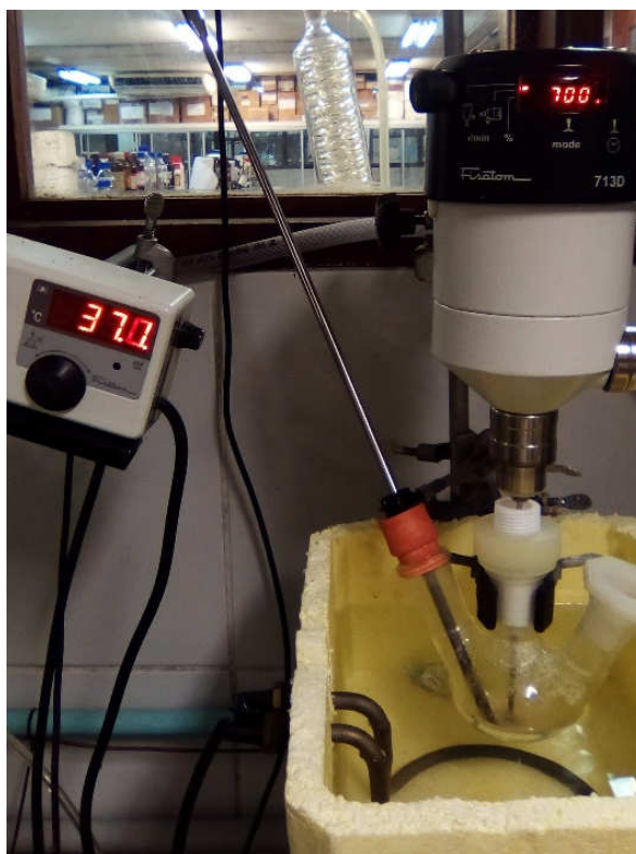
Figura 11: Sistema reacional adaptado para realizar as reações de avaliação da atividade hidrolítica
