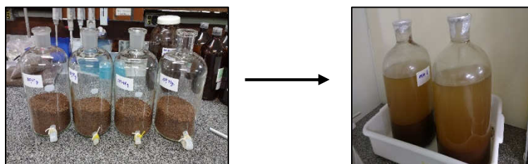
Figura 9: Processo de extração por maceração a frio com hexano em Mariote.
