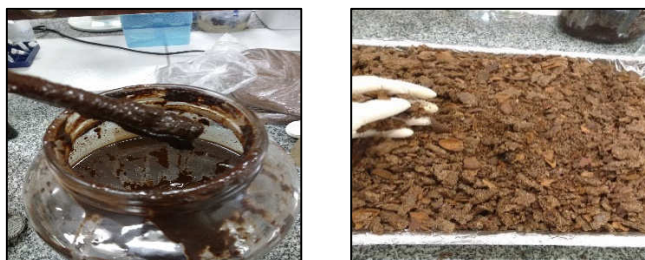
Figura 8: À esquerda, o resíduo do processo de filtragem do óleo obtido por prensa mecânica e à direita o resíduo do que é colocado dentro da prensa mecânica para realizar a extração.
