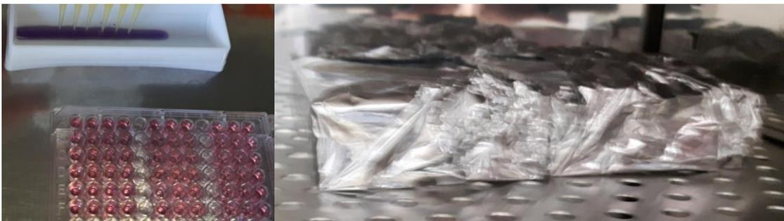
**Figura 4.2** – Métodos do ensaio de resazurina. A microplaca recebe a alíquota de 10 $\mu$ L de resazurina de cor azul purpúrea, após incubada por 24 horas com os tratamentos de cada grupo, sem haver a necessidade de lavar o meio de cultura condicionado pelos elutos de cada grupo. À direita: as microplacas são incubadas por 4 horas em seguida e devem ser protegidas da luz para não haver interferência da luminosidade do ambiente no reagente do ensaio.
