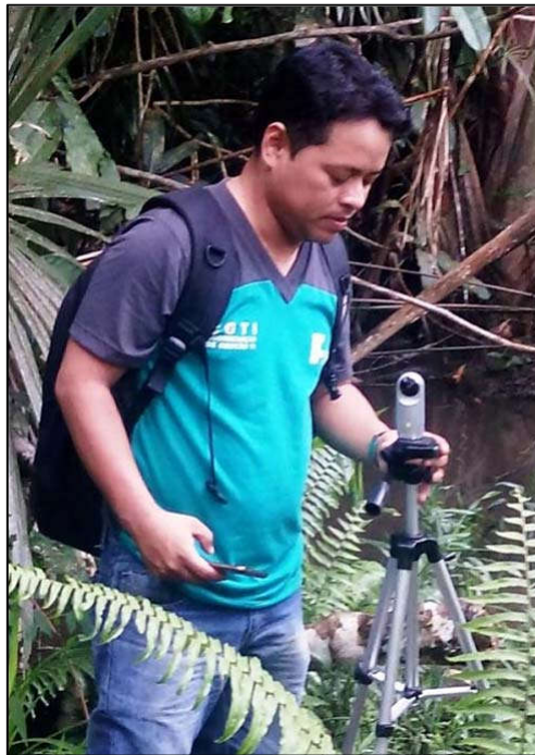
Figura 3 - Instalação da Câmera Fotográfica LGR105 para obtenção de imagem esférica em 360°, IFAM Tabatinga AM-2018.
