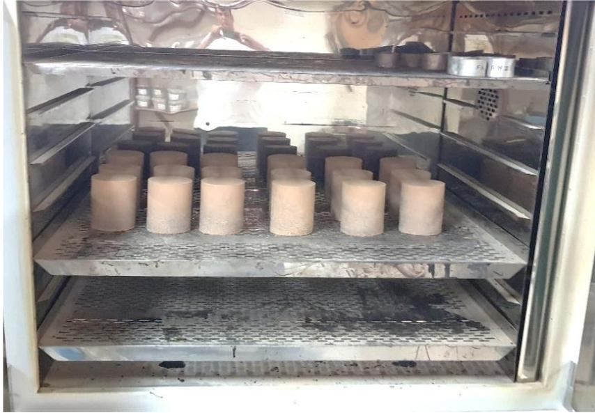
Figura 26 - Corpos de Prova das composições com ECOLOPAVI® em estufa para secagem a 60 °C.
