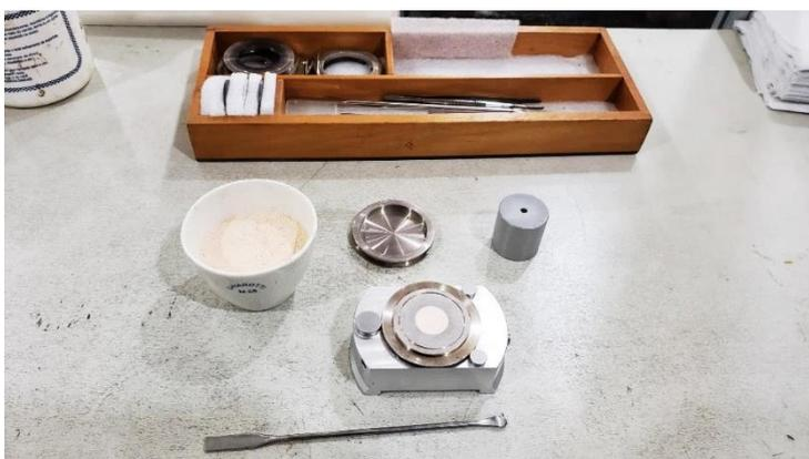
Figura 20 - Amostra do Solo natural e demais utensílios para teste de DRX.
