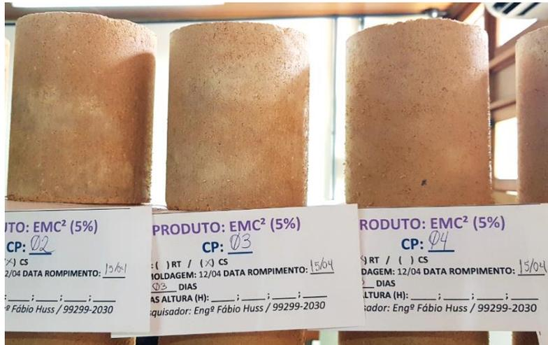
Figura 28 - Corpos de prova das composições com EMC<sup>2</sup>® em processo de cura.
