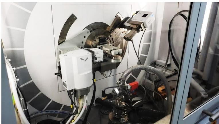
Figura 17 - Difratorômetro de Raio X da PANalytical - Empyrean.
