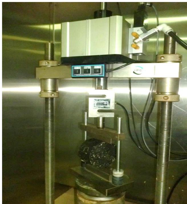
Figura 29 - Rompimento de CP no ensaio de Resistência à Tração.
