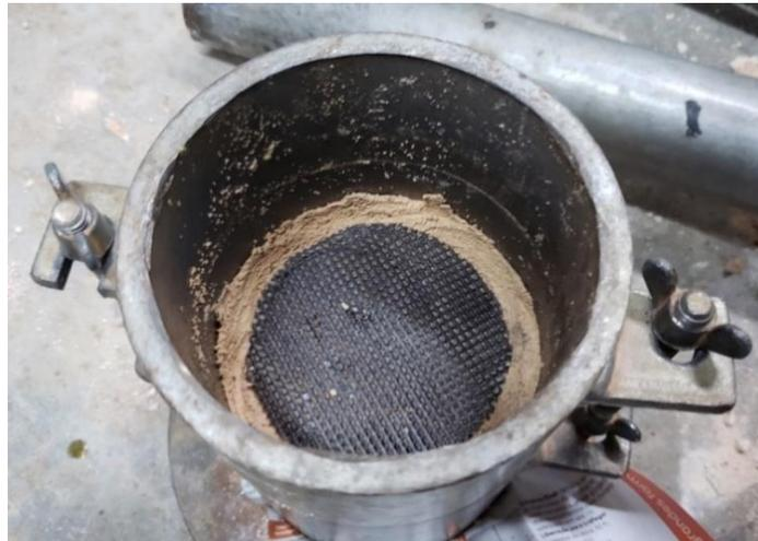
Figura 34 - Geogrelha posicionada no molde cilíndrico durante o processo de compactação.
