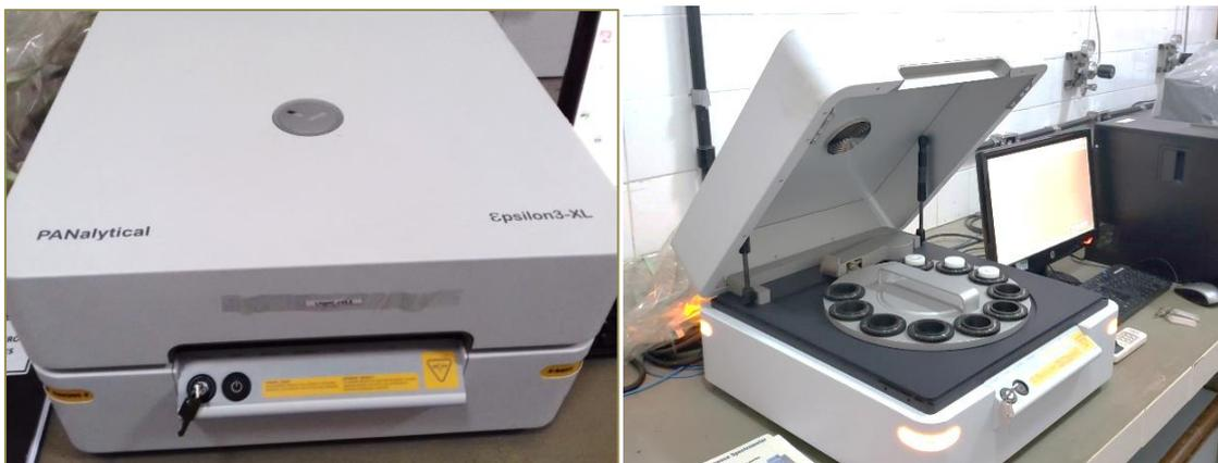
Figura 16 - Espectrômetro de fluorescência de Raios X da PANalytical - Epsilon 3XL.
