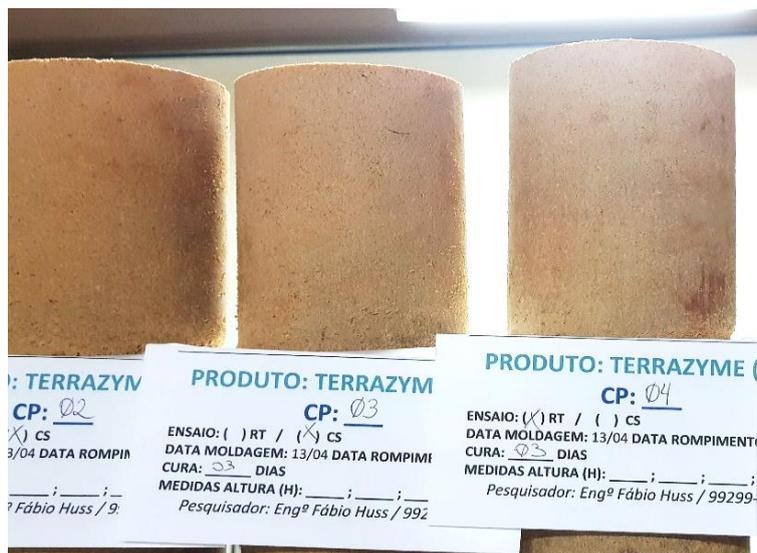
Figura 27- Corpos de prova das composições com TERRAZYME® em processo de cura.
