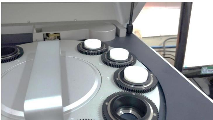
Figura 19 - Amostras do Solo natural sendo preparadas para ensaio de FRX.
