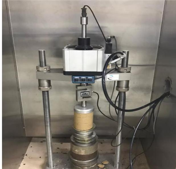
Figura 31 - Rompimento de CP no ensaio de RCS.
