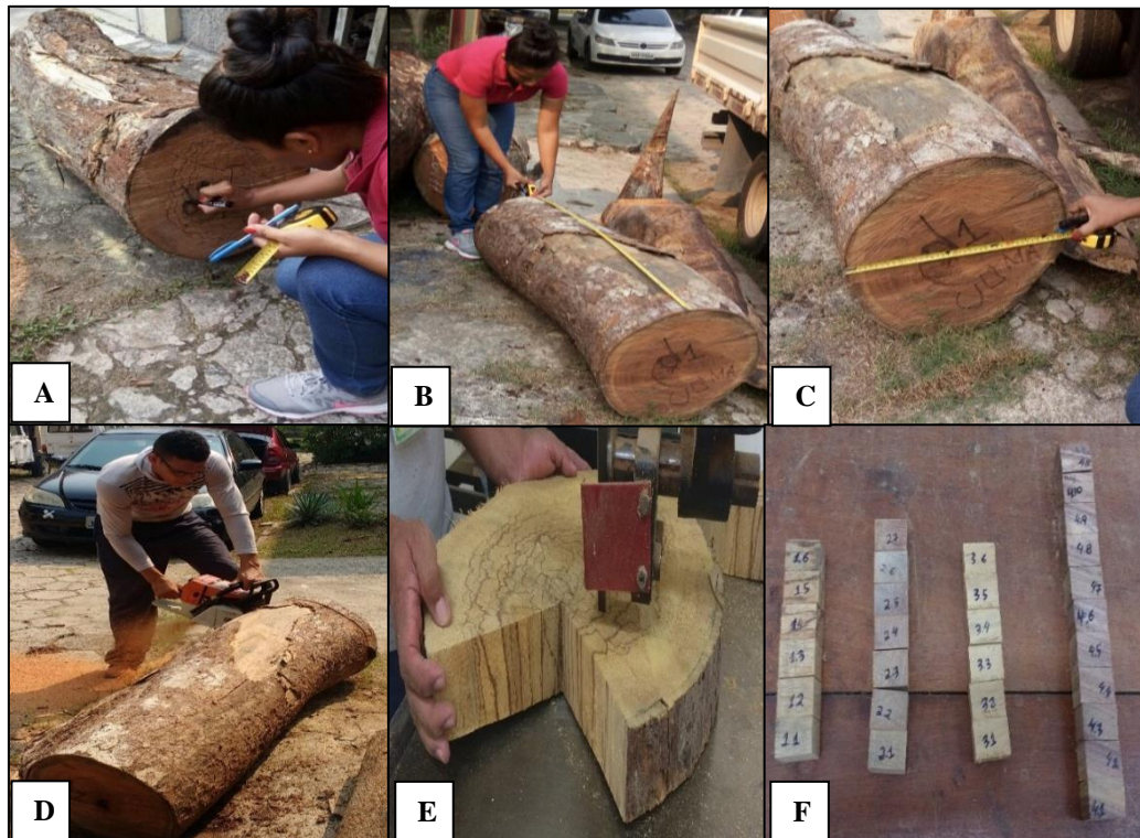
Figura 16 - Esquema dos processos para obtenção do volume do material lenhoso, identificação anatômica e propriedades físicas.
