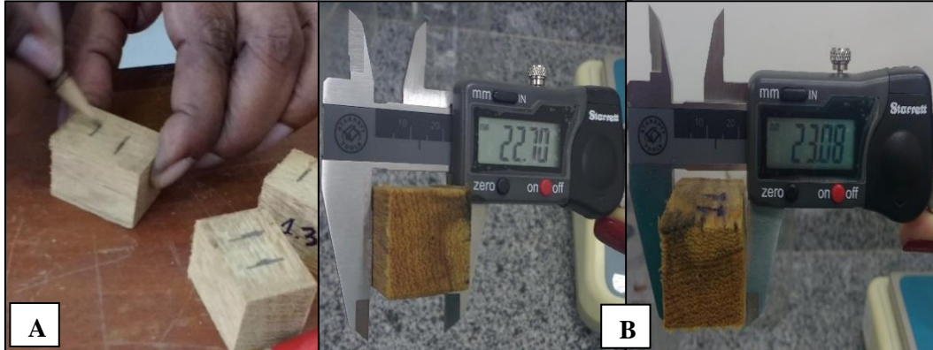
Figura 20 - Determinação da estabilidade dimensional dos corpos de prova. Fonte: Autor, 2018.
