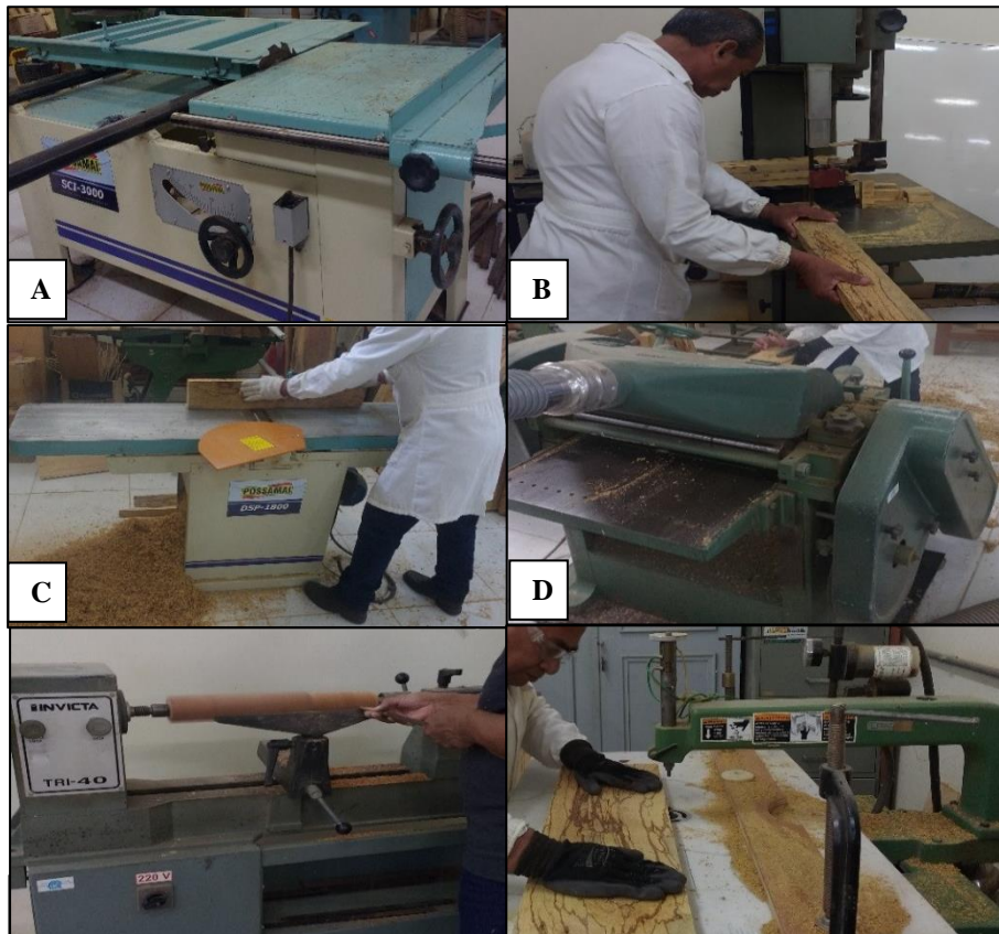
Figura 21 - Equipamentos utilizados no processamento mecânico para produção dos móveis. A: Serra circular; B: Serra fita; C: Desempenadeira; D: Plana desengrossadeira; E: Torno e; F: Tupia. Fonte: Autor, 2018.
