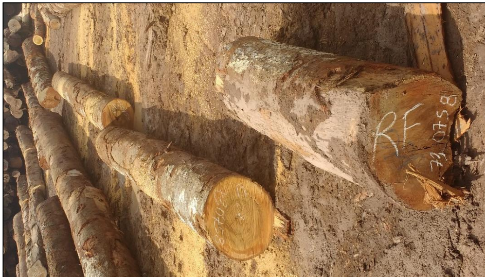
Figura 23 - Seccionamento da tora em função dos pedidos dos clientes. Fonte: Autor, 2017.
