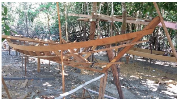
Figura 10 – Construção de canoa
