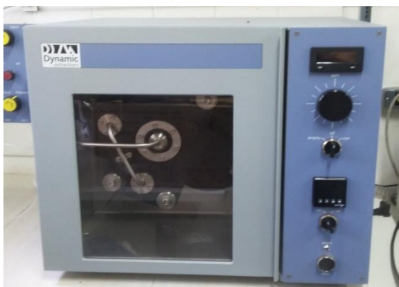
Figura 16: Cromatógrafo em Contracorrente de Alta Performance usado nas análises do presente trabalho – Laboratório de Produtos Naturais do Departamento de Química - UFAM
