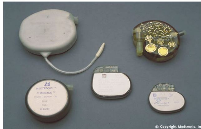
FIGURA 2: Exemplos de marca-passos implantáveis, com diferentes tamanhos e formas.
