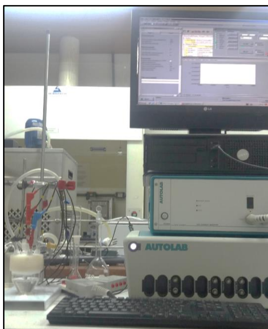
Figura 7 – Célula eletroquímica de três eletrodos conectada ao potenciostato.
