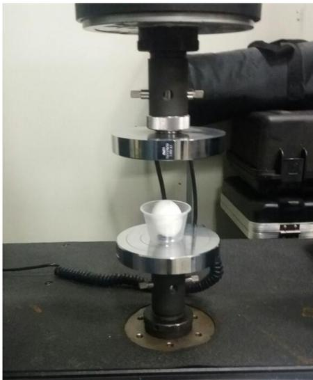
Figura 5 - Teste de determinação da força de ruptura da casca.
