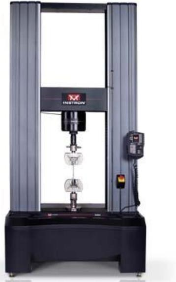
Figura 4 - Máquina de ensaio universal.
