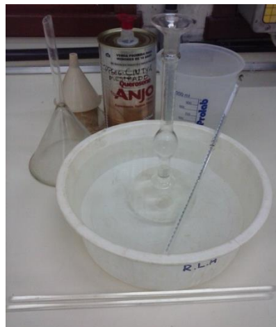
Figura 3-12- Frasco volumétrico de Le Chatelier - UFAM/AM
