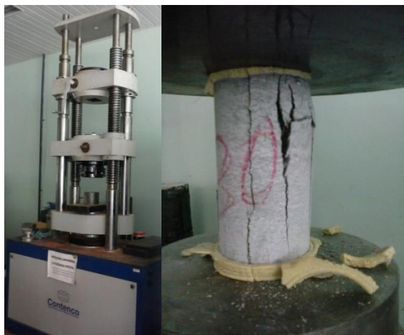
Figura 2.1 – Máquina Universal eletrônica hidráulica (a); ensaio de compressão 30% de metacaulinita aos 7 dias (b).
