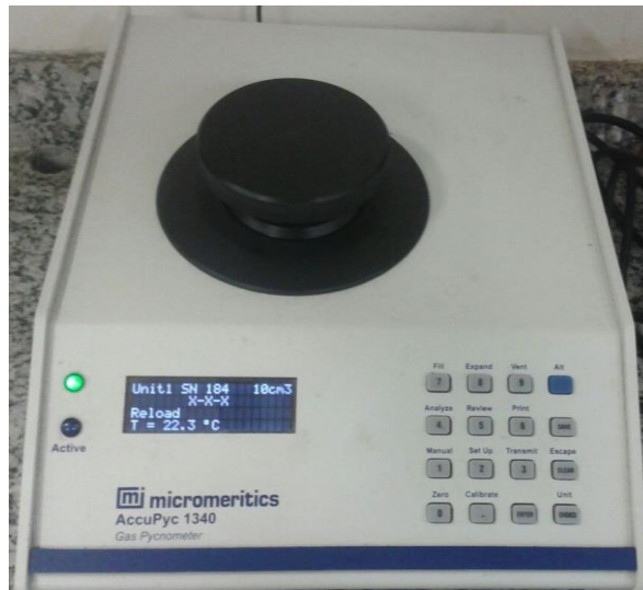
Figura 3-11- Pícnometro a gás (hélio) - COPPE/UFRJ.
