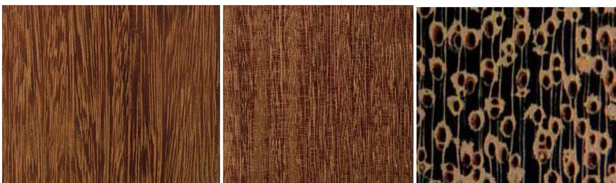
FIGURA 3 - Fotos das faces tangencial, radial e fotomicrografia da madeira de *Andira parviflora* Ducke (Sucupira-Vermelha).
