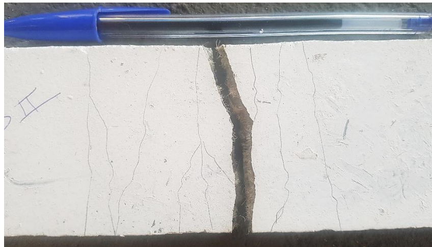
Figura 37- Modo de ruptura do painel sanduíche após o ensaio de flexão
