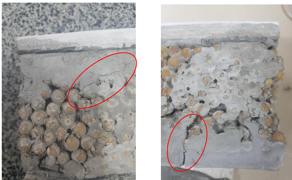
Figura 39- Fissura de cisalhamento no núcleo
