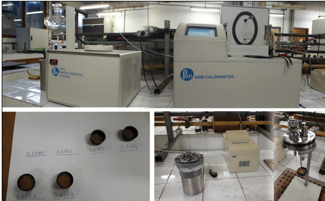
Figura 14 - Calorímetro PARR e amostras para determinação do PCS
