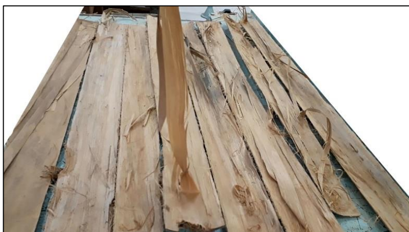
Figura 23 - Estrutura fibrosa das madeiras de matamatá
