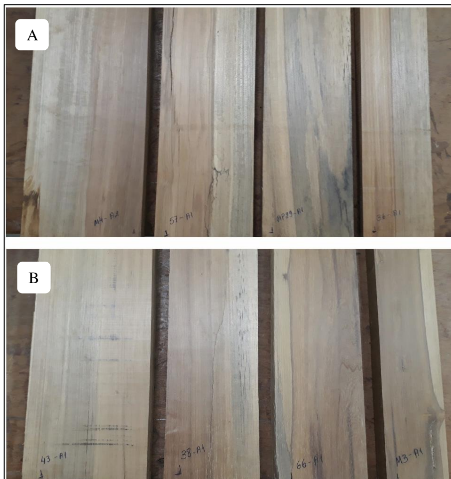
Figura 24 - Resultado do teste de aplainamento (A) E. coriacea e (B) E. truncata
