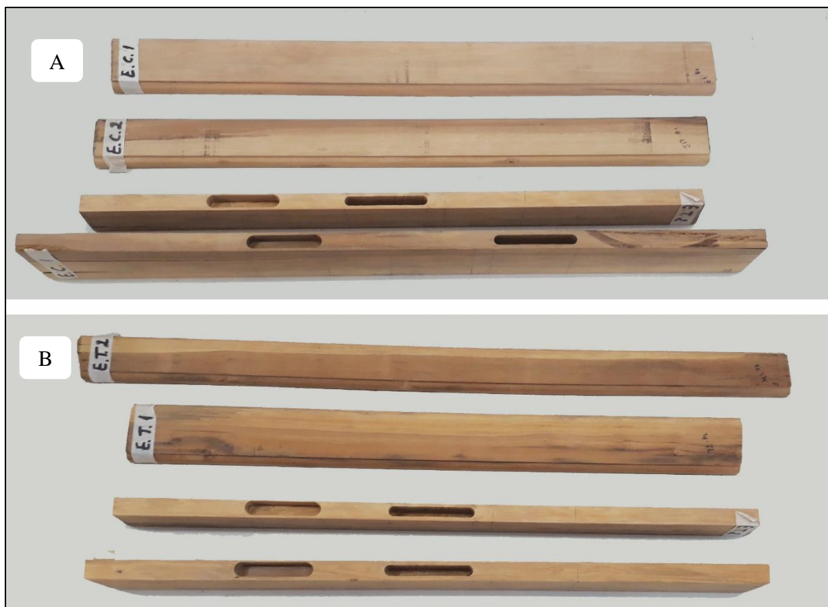
Figura 27 - Resultado do teste de moldura do topo e rasgo lateral (A) E. coriacea e (B) E. truncata
