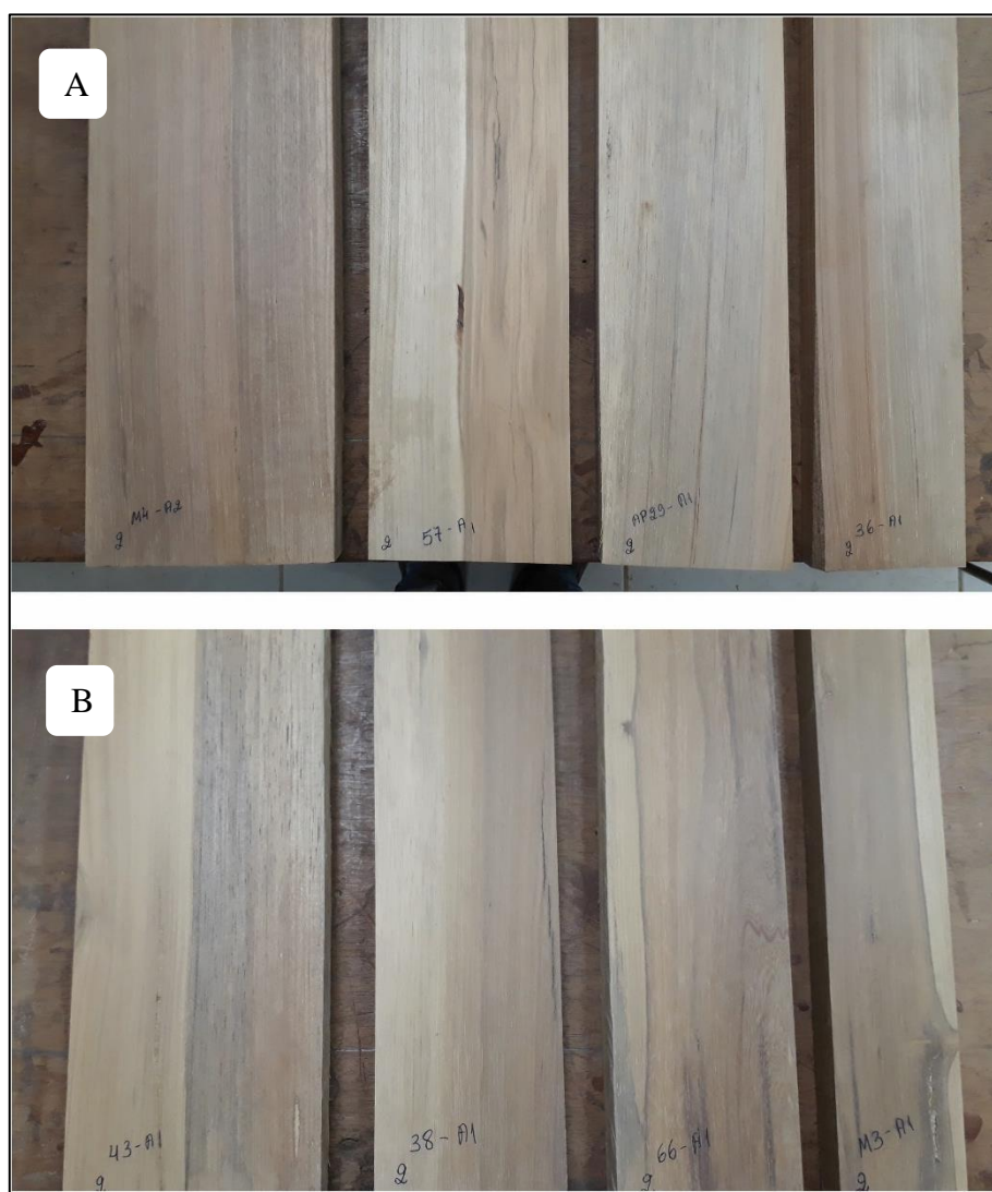
Figura 25 - Resultado do teste de Lixamento (A) E. coriacea e (B) E. truncata
