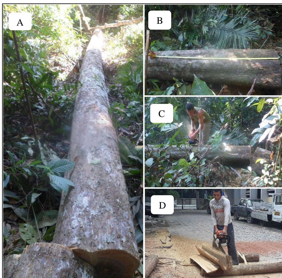
Figura 6 –Corte das toras (A, B e C) e Desdobro das pranchas (D)
