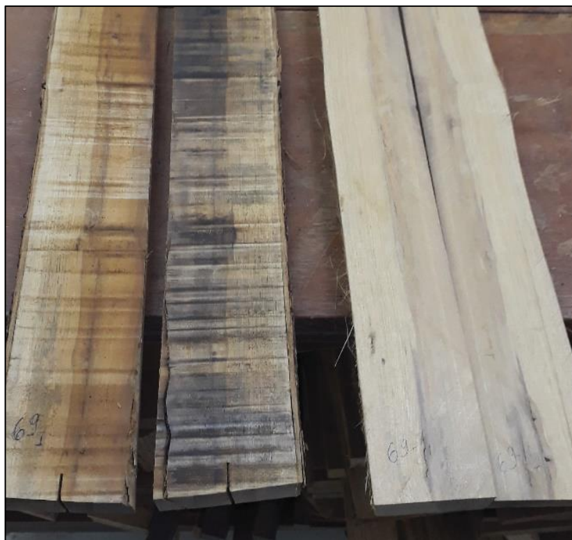
Figura 29 - Diferença de resultado de corte com ferramenta inadequada e ferramenta adequada.
