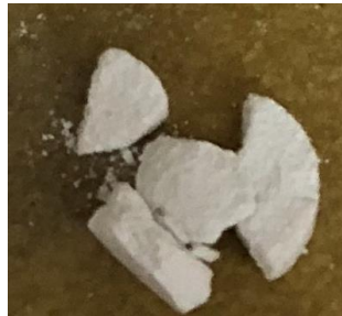
Figura 19 – Imagem do pellet compactado em 42 MPa.
