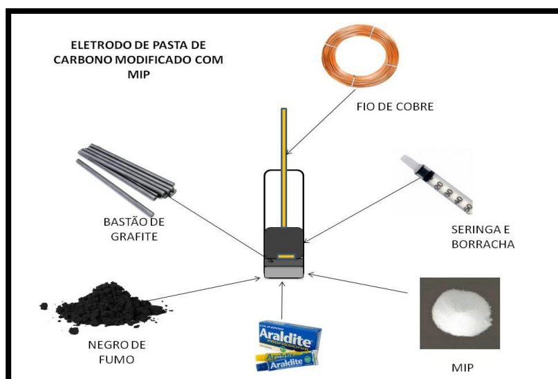
Figura 9: Esquema de preparação do eletrodo modificado com MIP.
