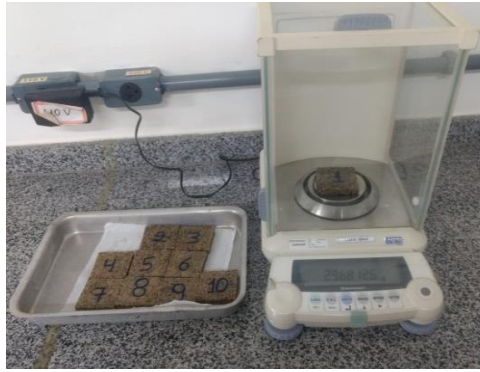
Figura 27. Pesagem dos corpos de prova após 24 h de ensaio.
