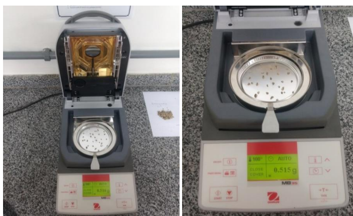
Figura 15. Amostra de açai no Analisador Halogêneo para determinação do teor de umidade.
