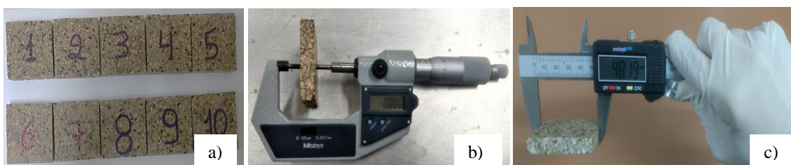
Figura 25. Ensaio de densidade: a) Corpos de prova; b) Medição da espessura dos corpos-de-prova; c) Medição do comprimento e da largura dos corpos de prova.
