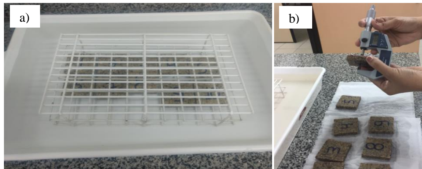
Figura 26. Ensaio de inchamento: a) Imersão dos corpos de prova; b) Medição dos corpos de prova após a imersão.
