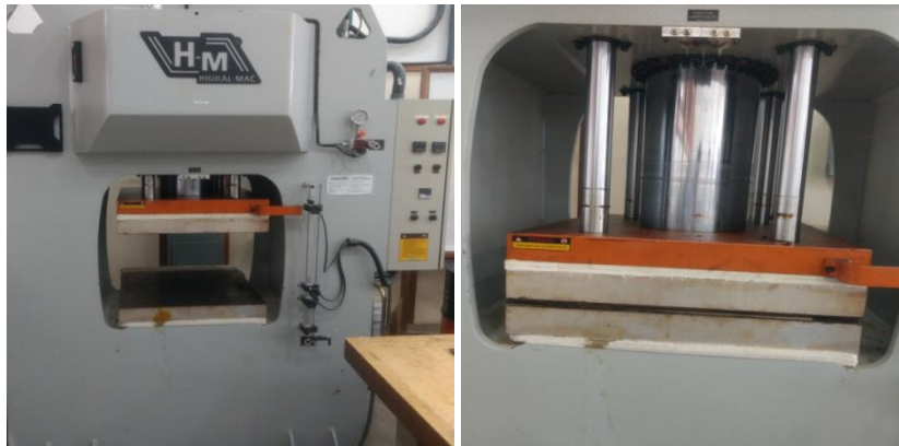
Figura 21. Prensagem a quente do painel na prensa hidráulica PHH 100T, da Hidral-mac.
