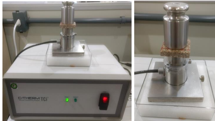
Figura 31. Ensaio de condutividade térmica na superfície do compósito.
