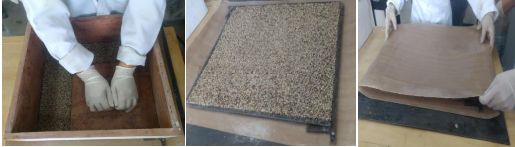
Figura 20. Moldagem e compactação manual das partículas.
