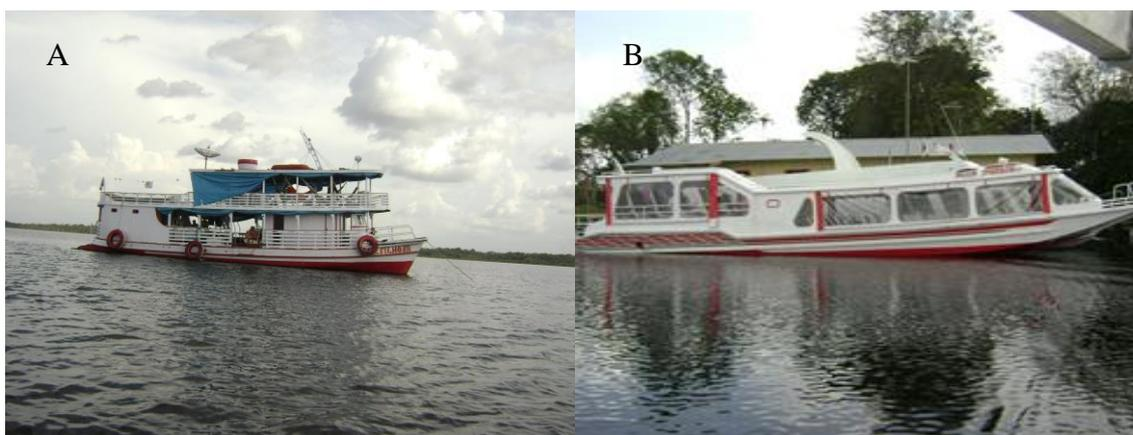
Figura 3: transporte fluvial: A - barco regional de madeira. B - motor “ajato”, que serve para o transporte de passageiros e cargas no lago Janauacá
