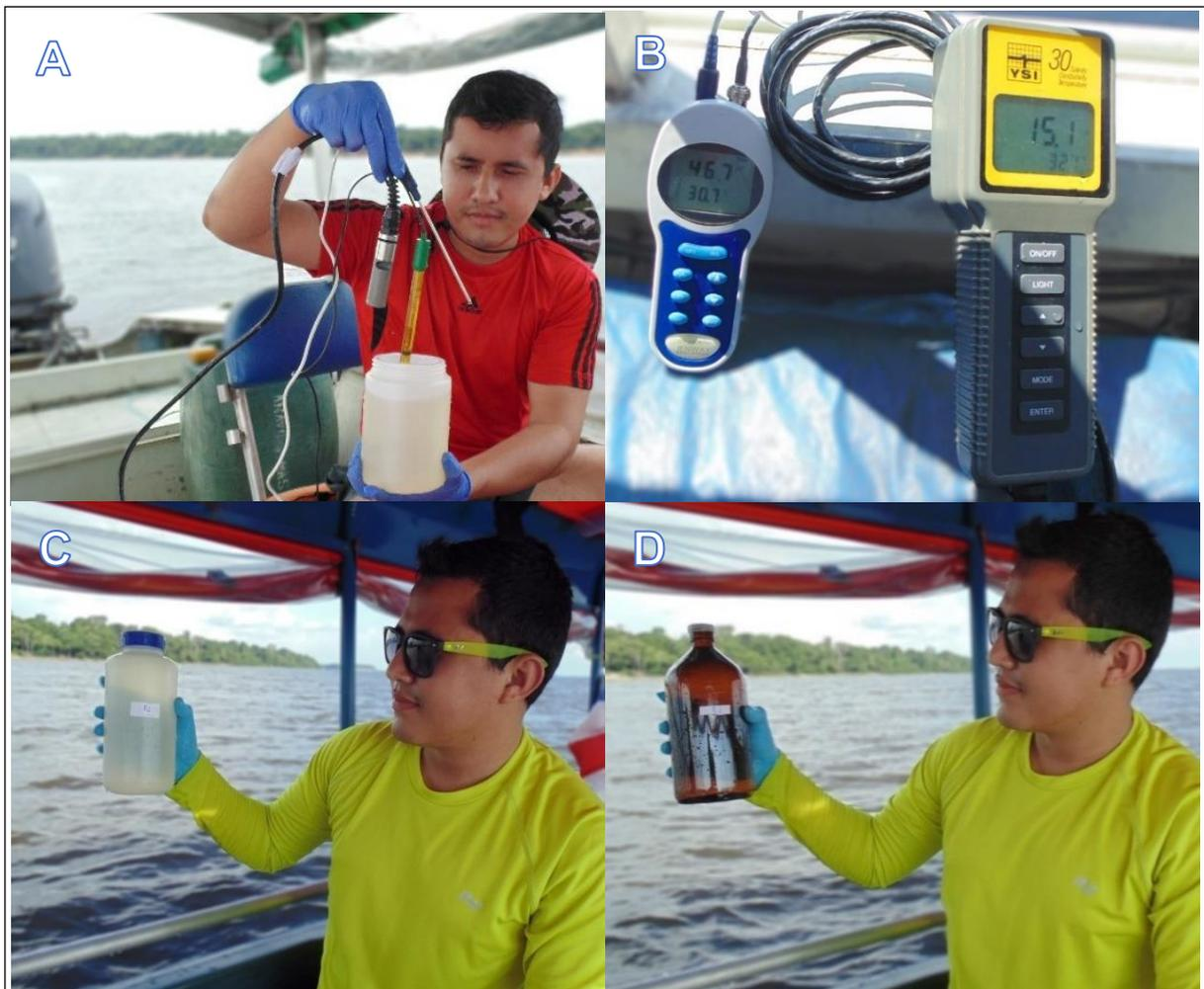
**Figura 9.** Coleta de amostras. (A) Amostragem em garrafa de polietileno para medição *in loco* de CE, ORP, pH e Temperatura; (B) Sondas multiparamétricas portáteis; (C) Garrafa de polipropileno para análise de metais; (D) Garrafa de vidro âmbar para análise de orgânicos. Fonte: O autor (2017).
