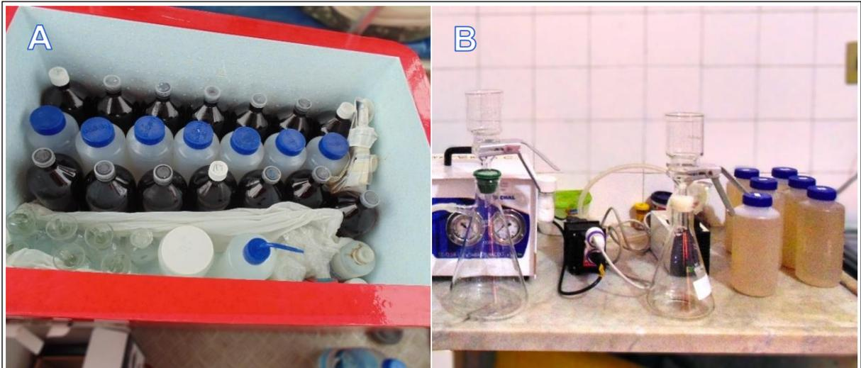
**Figura 11.** Armazenamento e filtração para determinação de sólidos totais suspensos.
