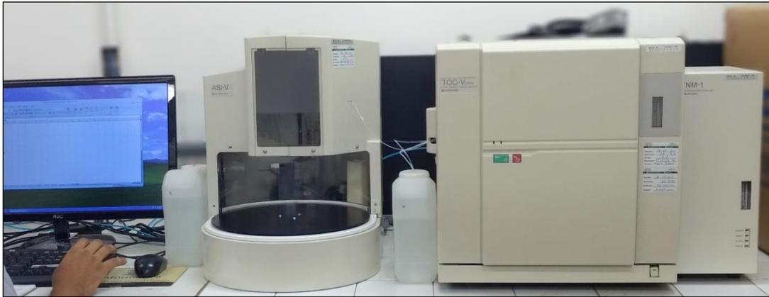
**Figura 14.** Amostrador ASI-V e analisador de carbono Shimadzu TOC-V<sub>CPH</sub>.
