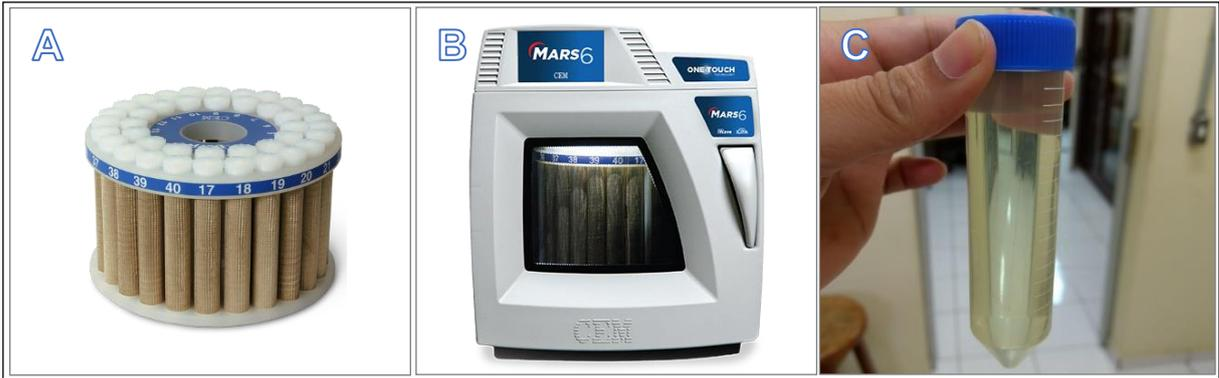
**Figura 15.** Sistema de digestão de amostras. (A) Carretel com tubos teflon; (B) Forno-digestor micro-ondas CEM, Modelo MARS 6; (C) amostras digeridas de filtros. Fonte: (A) e (B) CEM (2018); (C) O autor (2017)
