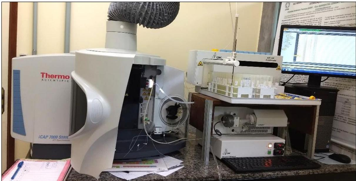
**Figura 17.** Espectrômetro de emissão atômica com plasma indutivamente acoplado.
