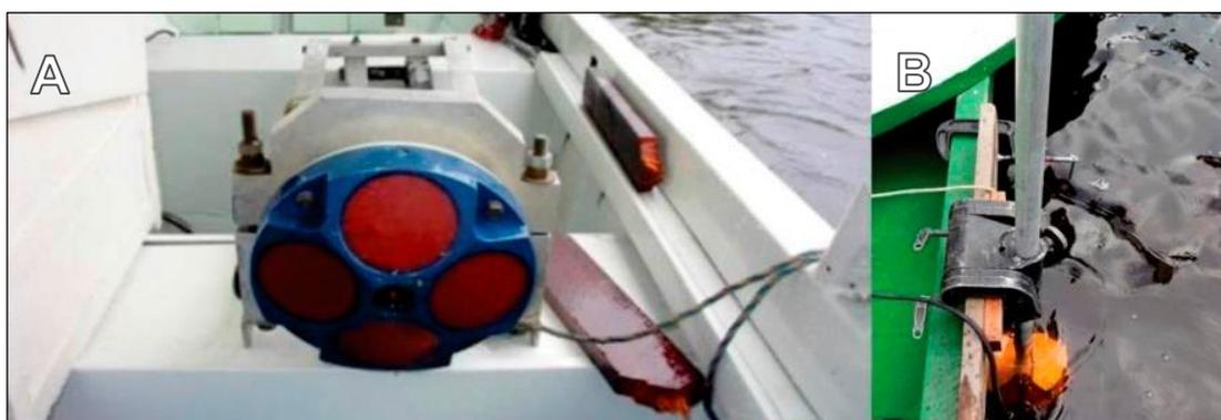
**Figura 18.** Perfilador Doppler Acústico de Corrente (ADCP). **(A)** ADCP utilizado na pesquisa; **(B)** em operação a 50 cm da linha d'água. Fonte: Marinho et al. (2019).
