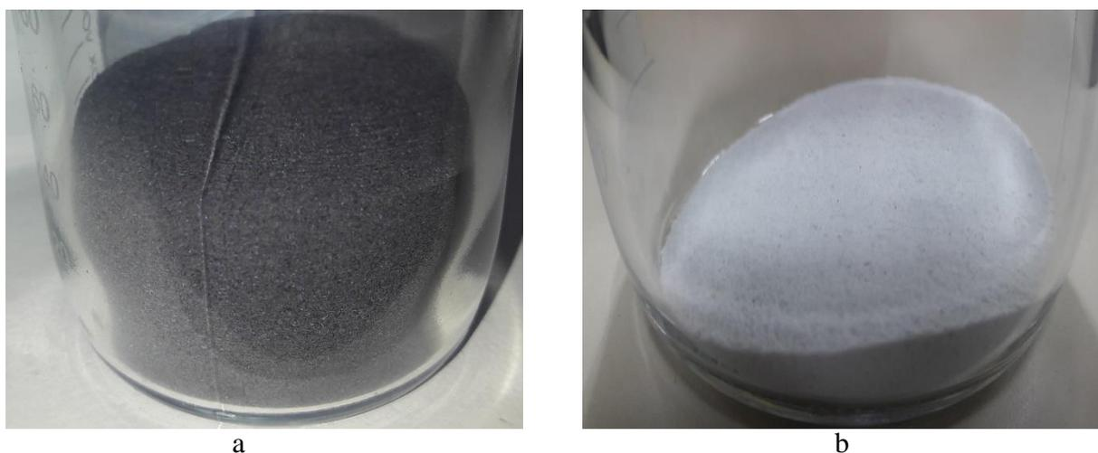
Figura 08: Amostra calcinada a  $500^{\circ}\text{C}$  em “a” e amostra calcinada a  $750^{\circ}\text{C}$  em “b”.
