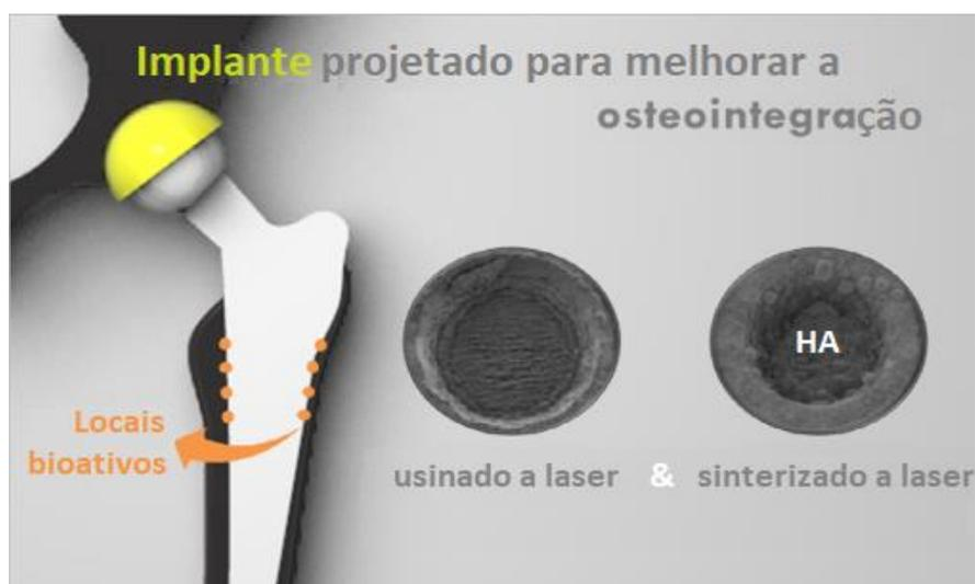
Figura 01 : Projeto de implante de quadril usando tecnologia laser. (adaptado de MIRANDA et. al, 2019)
