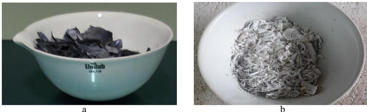
Figura 07: a) Escama calcinada a  $500^{\circ}\text{C}$ ; b) Escama calcinada a  $750^{\circ}\text{C}$
