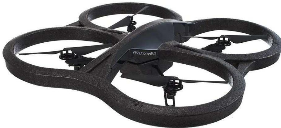
Figura 6.4: Veículo robótico aéreo utilizado nos experimentos reais (AR.Drone 2.0).
