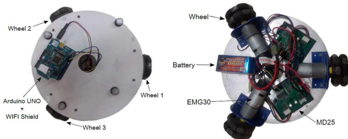
Figura 6.3: Vista superior (esquerda) e inferior (direita) do Omni-ANT.
