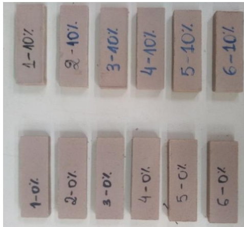
Figura 7 - Corpos de Prova prensado antes da queima com 8% de água. Fonte: Autor, (2019).
