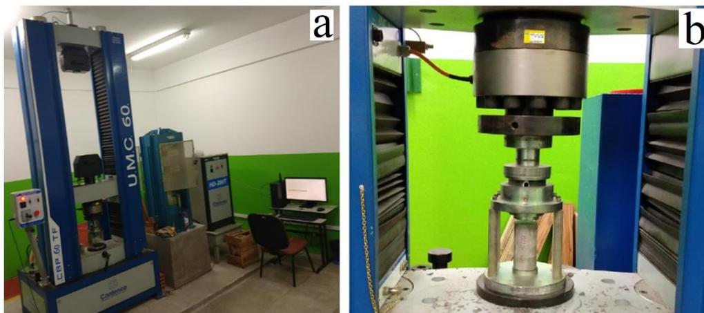
Figura 53: máquina universal mecânica (a), corpo-de-prova centrado (b).
