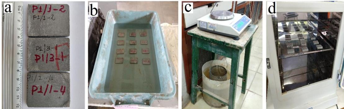
Figura 66: amostras (a); amostras imersas (b); balança hidrostática digital (c); e estufa elétrica (d).
