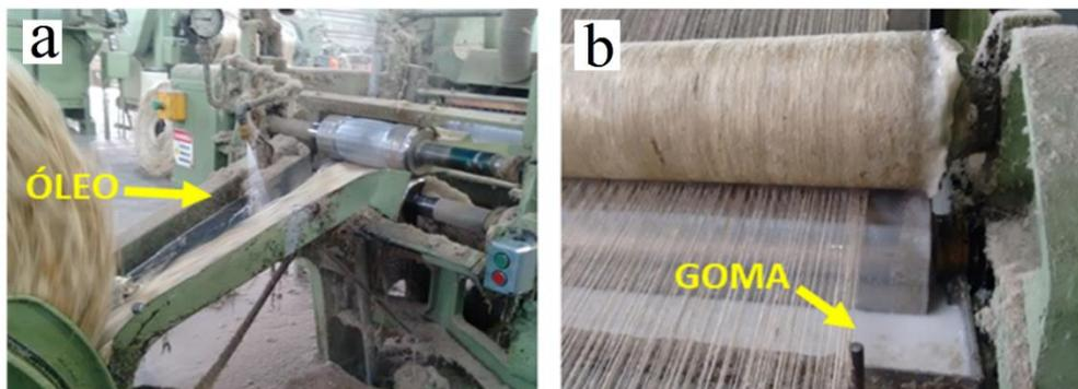
Figura 21: tratamento de óleo vegetal nas fibras (a) e impermeabilização dos cordões de juta com goma (b).
