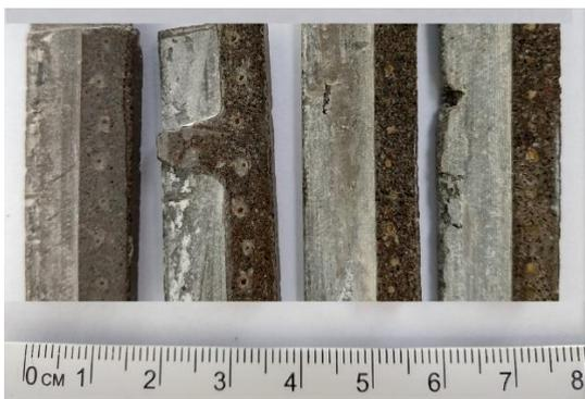
Figura 70: amostras dos corpos-de-prova, com armadura têxtil e com tecido de juta, utilizadas na microscopia.
