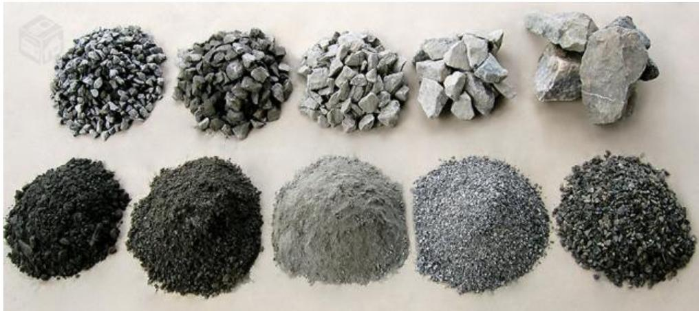
Figura 10: diversos tipos e tamanhos de agregados
