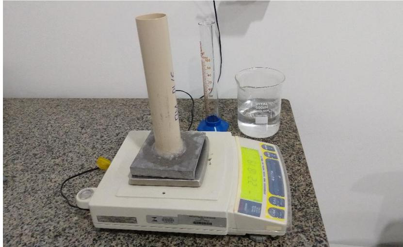
Figura 68: pesagem da massa do corpo-de-prova com água, na determinação da impermeabilidade.
