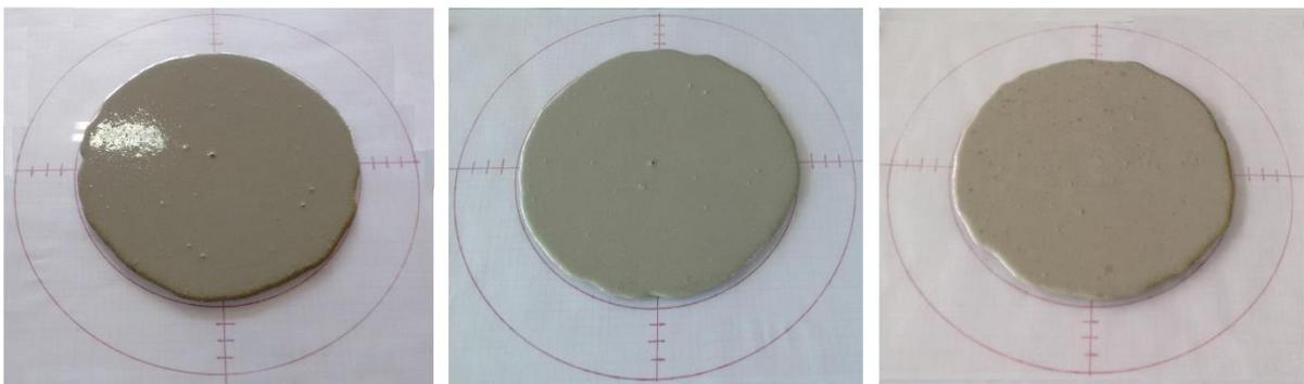
Figura 84: ensaios de mini slump, espalhamento das pastas dos limites inferior, intermediária e superior
