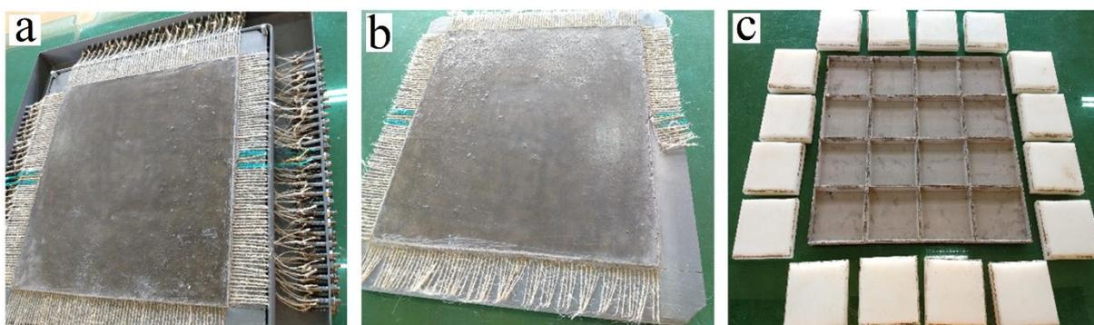
Figura 60: Corte dos cordões (a); desencaixe e aparas das pontas (b); retiradas dos módulos de nylon (c).
