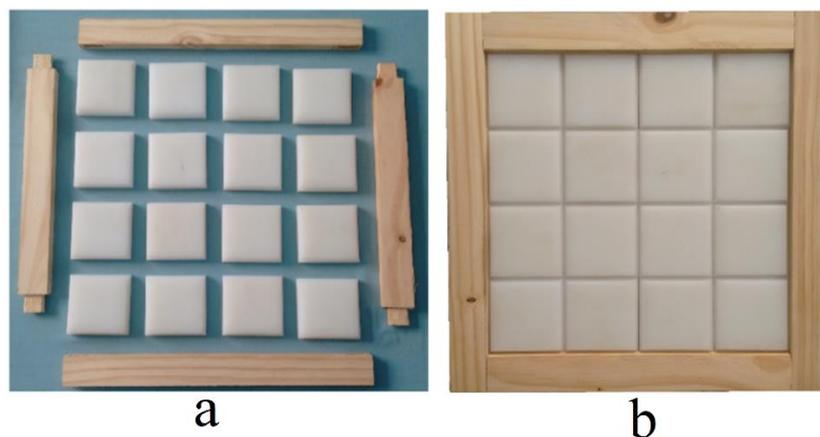
Figura 55: molde desmontado (a) e montado (b).
