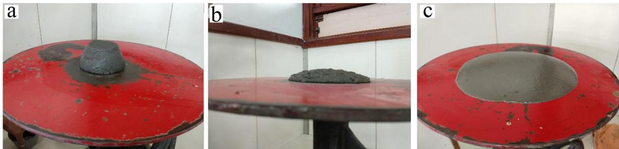
Figura 51: consistências dos traço de referência inferior (a), intermediário (b) e superior (c).
