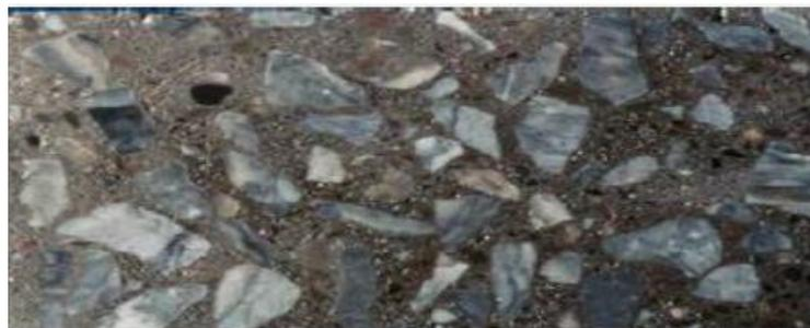
Figura 4: macro estrutura de um concreto.
