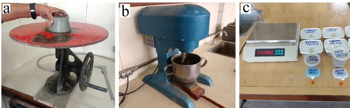
Figura 52: Mesa de *Graff* (a), argamassadeira elétrica (b) e balança eletrônica digital (c).
