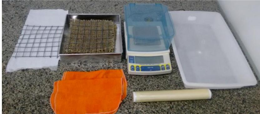
Figura 42: materiais, utensílios e equipamento utilizados durante o procedimento de permeabilidade.
