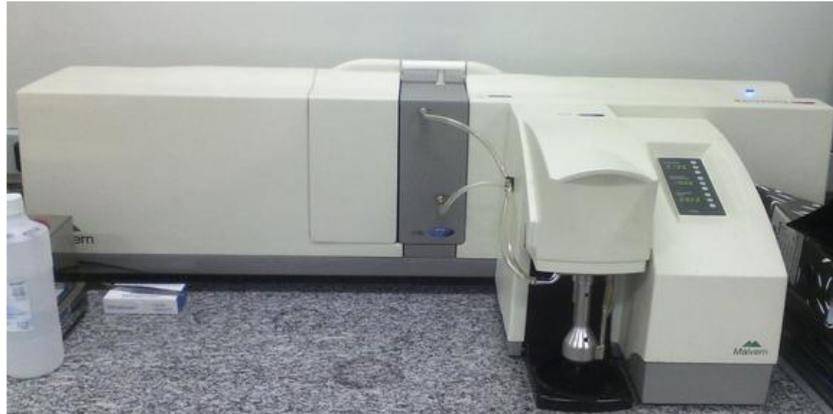
Figura 29: instrumento para dimensionamento de partícula a *Laser*.
