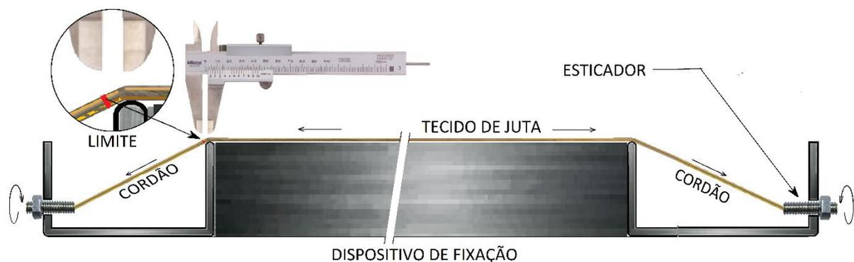
Figura 37: secção do dispositivo de fixação - aplicação da força de pré-tração.
