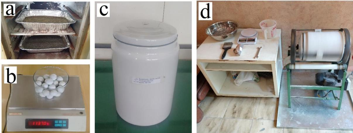
Figura 33: estufa com pó de brita (a), balança com bolas (b), jarro (c) e moinho de bolas (d).
