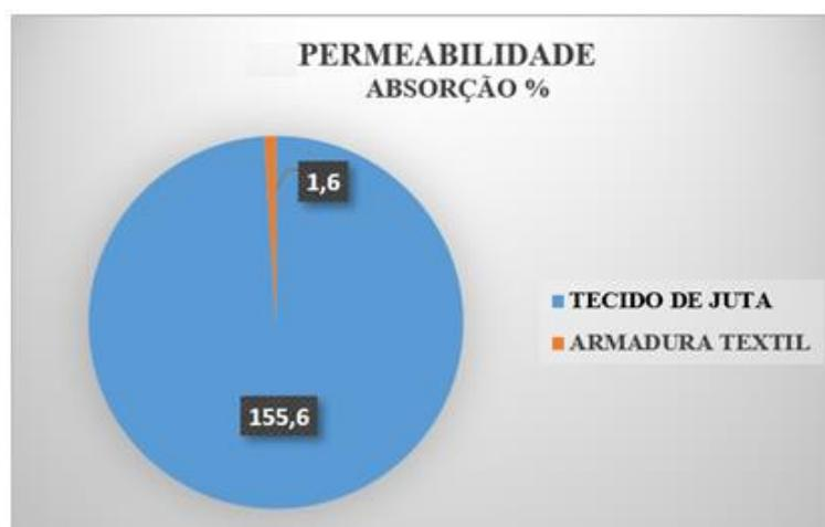
Figura 79: Gráfico dos ensaios de absorção, para a avaliação da permeabilidade da armadura têxtil.
