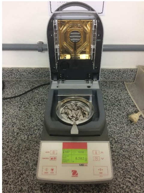
Figura 10. Avaliação da umidade residual do resíduo no analisador halogêneo de umidade. Fonte: Autora.
