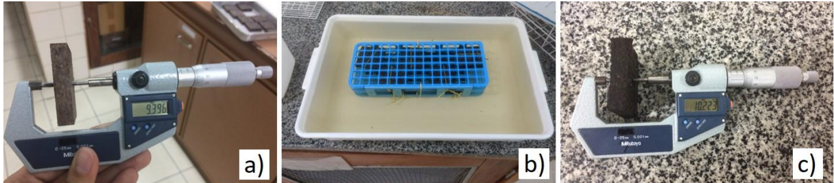
Figura 7. a) medição da espessura inicial; b) imersão dos corpos-de-prova em água destilada; c) medição da espessura final. Fonte: Autora.
