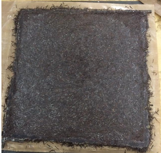
Figura 15. Painel compósito após desforma. Fonte: Autora.
