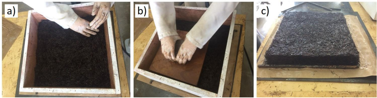
Figura 13. a) material distribuído na fôrma de madeira; b) material sendo pré-pensado manualmente; c) material disposto sobre bandeja metálica e molde metálico, após retirada de fôrma de madeira. Fonte: Autora.
