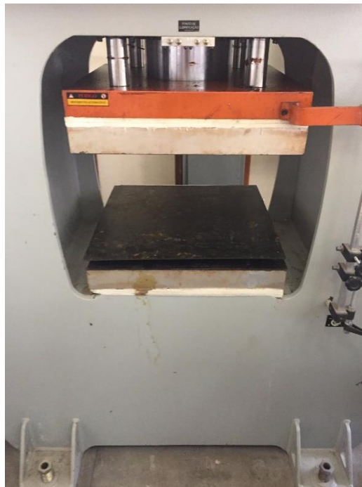
Figura 14. Material posicionado na prensa hidráulica para a execução da técnica. Fonte: Autora.
