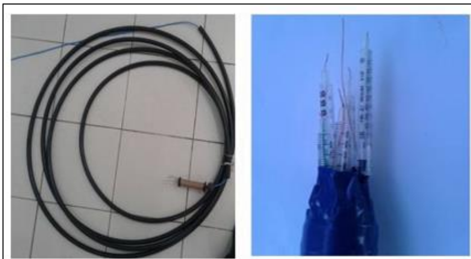
Figura 8. Fios na função de eletrodos adaptado para detectar o nível da água
