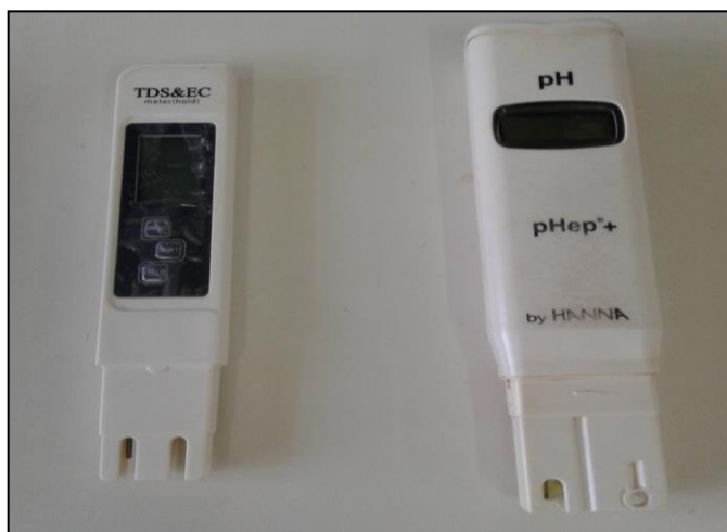
Figura 15. Sondas digitais de CE; STD, T(°C) e pH.
