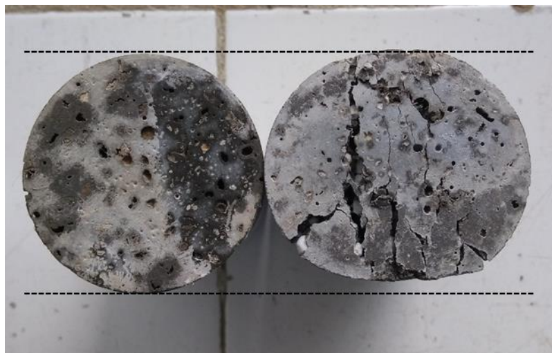
Figura 32 – Configuração do corpo de prova (1M60) após ensaio de resistência à tração por compressão diametral, à direita.
