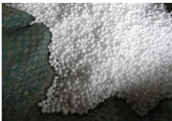
Figura 3– Pérolas de poliestireno expandido, EPS (CUI et al , 2016).
