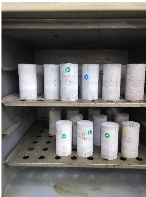
Figura 20 – Secagem dos corpos de prova em estufa com temperatura controlada
