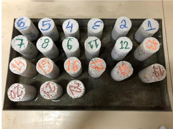
Figura 21 – Corpos de prova com face imersa em água para ensaio de absorção de água por capilaridade
