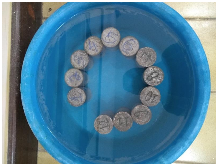
Figura 14 – Corpos de prova em condição de cura
