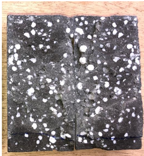
Figura 22 – Perfil de percolação de água no interior do corpo de prova
