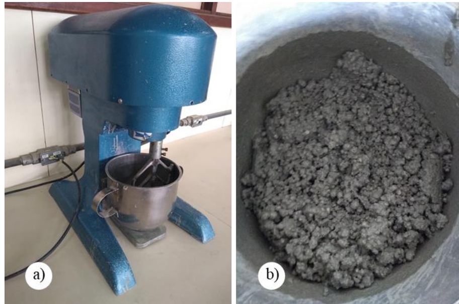
Figura 12 – Mistura dos materiais. a) Equipamento argamassadeira. b) Distribuição dos materiais na mistura
