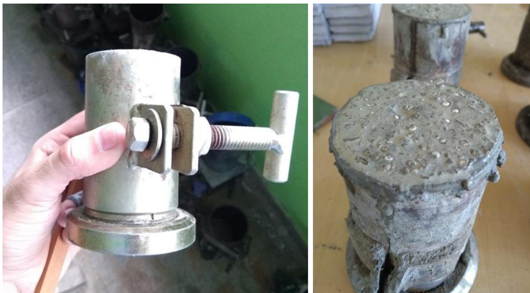
Figura 13 – Moldagem dos corpos de prova cilíndricos
