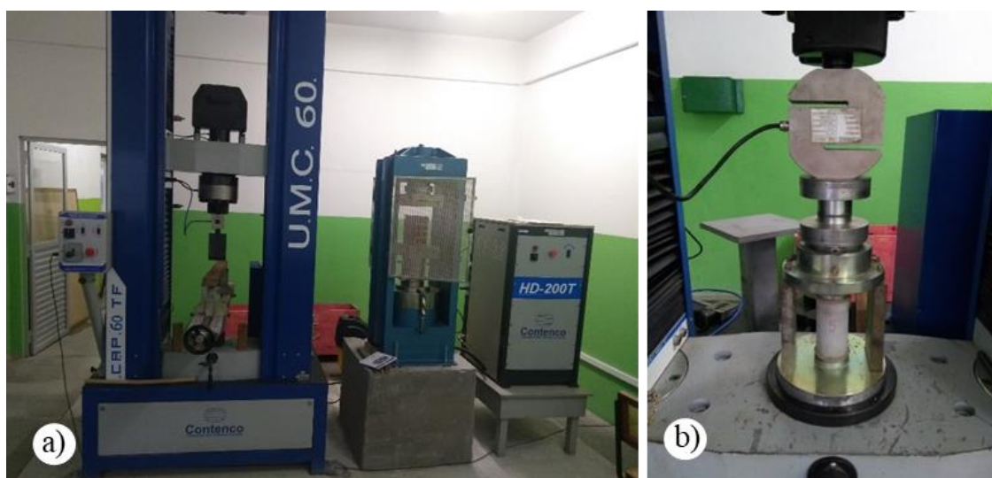
Figura 18 – Ensaio mecânicos. a) Prensa universal da marca Contenco. b) Ensaio de resistência à compressão axial
