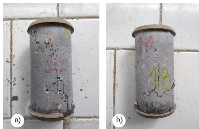
Figura 30 – Concreto leve com EPS-R após ruptura. a) com volume de 30% de EPS. b) 60% de EPS.
