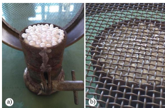
Figura 11 - Determinação do volume de vazios do EPS. a) recipiente preenchido totalmente por EPS. b) recipiente preenchido por EPS + água
