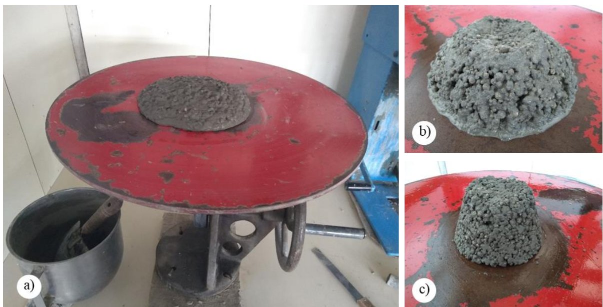
Figura 17 – Ensaio de espalhamento na mesa (flow table). a) Mistura contendo 30% de EPS. b) 45% de EPS. c) 60% de EPS
