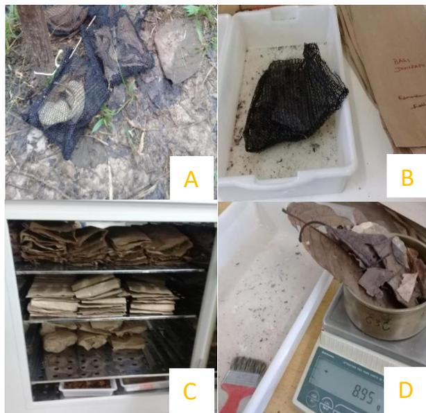
**Figura 3.** *Litter bags* instalados em áreas de reflorestamento (A); limpeza do material (B); secagem C; pesagem do material contido nas sacolas D.
