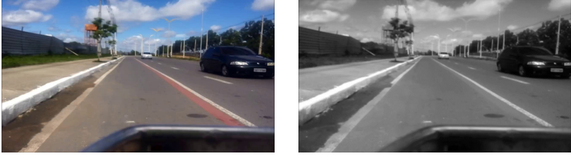
Figura 2.3: Filtragem da uma imagem utilizando-se um filtro blur Gaussiano, onde a esquerda tem-se a imagem original e a direita apresenta-se a filtragem utilizando-se um filtro blur com máscara de dimensões 5 \times 5 .
