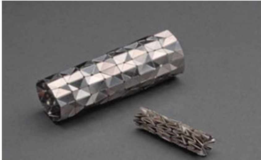
Figura 2.3: Stent origami projetado para fins medicinais.
