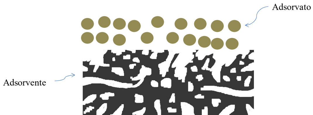
Figura 9. Ilustração do fenômeno da adsorção na superfície do carvão. As bolinhas marrom-claro representam moléculas do adsorvato que são adsorvidas na superfície do carvão (adsorvente).
