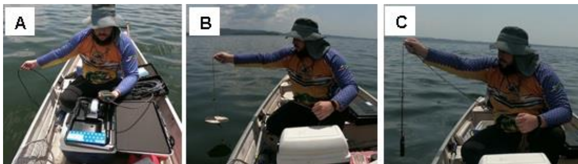
Figura 5 - Amostragem dos parâmetros físico-químicos da água: (A) potencial hidrogeniônico (pH), oxigênio dissolvido (DO mg·l -1 ), condutividade (μS·cm -1 ) e temperatura (oC); (B) transparência da água; (C) profundidade da coluna d'água.
