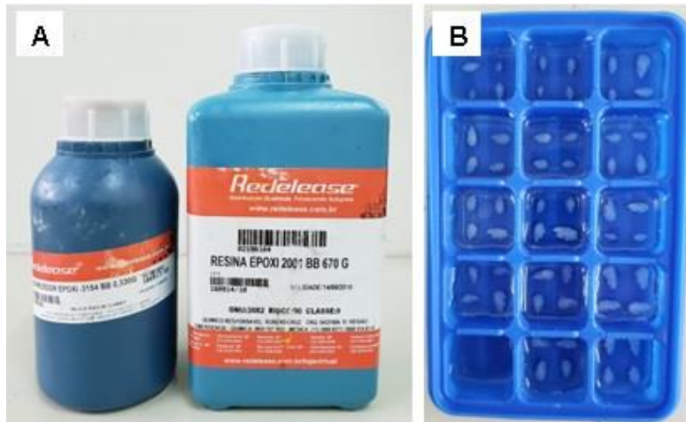
Figura 11 - Resina epoxídica araldite e forma de silicone, utilizadas no embocamento dos otólitos (A e B).
