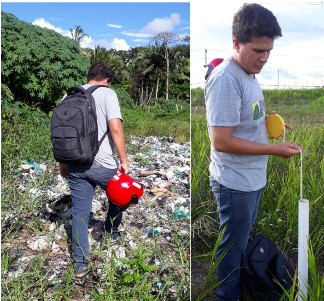
Figura 16 – Coletas do nível estático nos piezômetros
