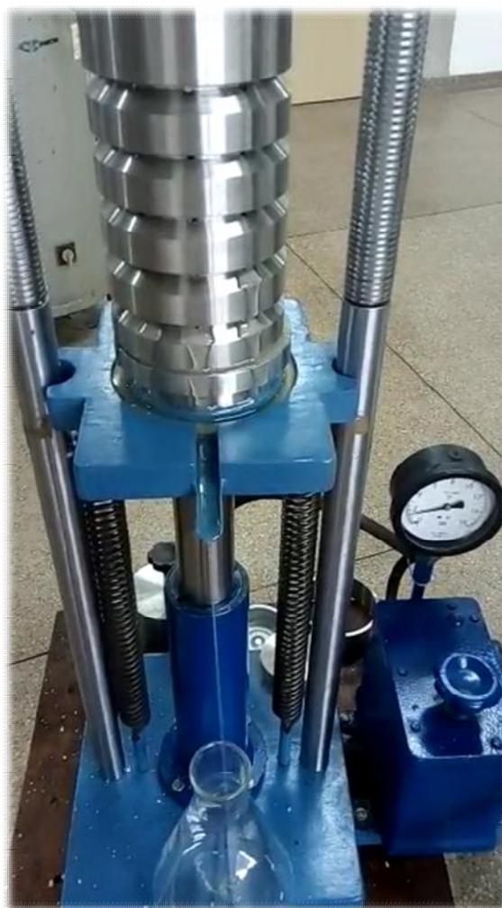
Figura 7 – Prensa mecânica utilizada para extração do óleo
