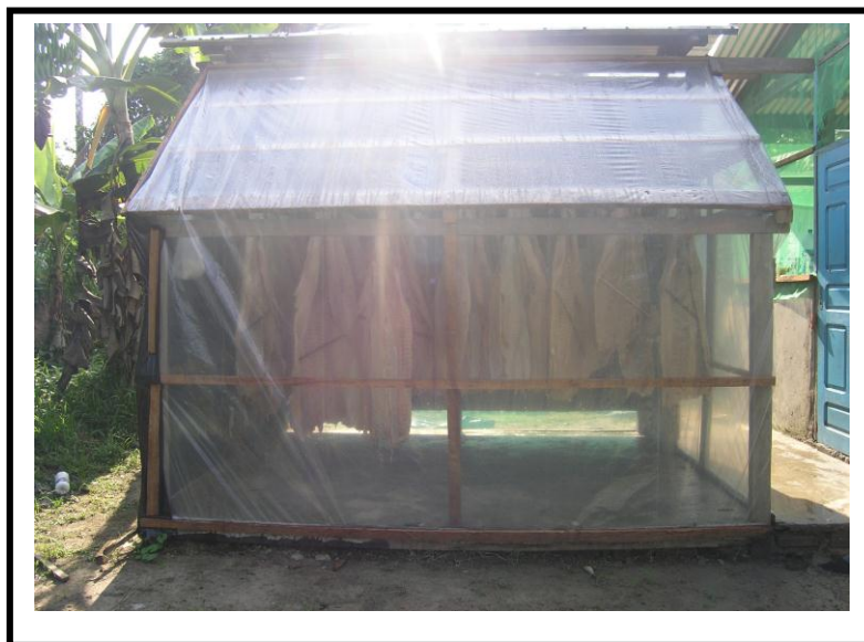
Figura 8 – Secador solar artesanal construído ao lado da unidade de salga de pescado.
