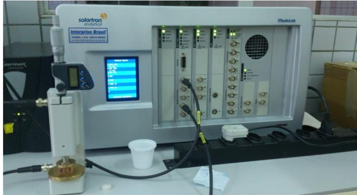
Figura 4.1: Analisador de impedância do tipo *Solartron Analytical AMETEK*
