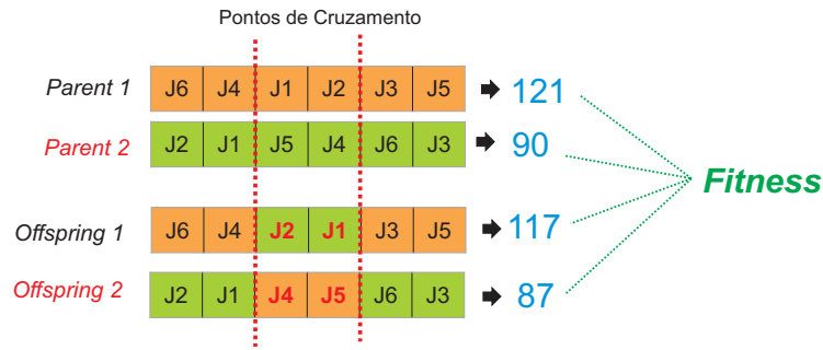
Figura 2.11: Cruzamento/recombinação usando método de dois pontos.
