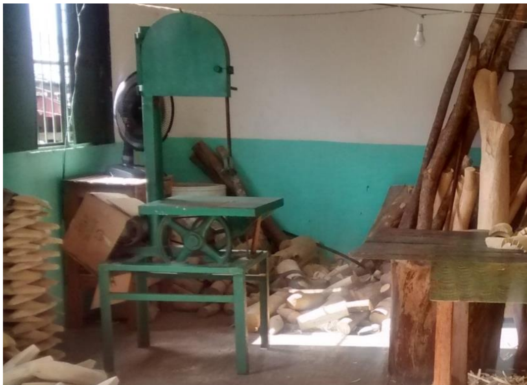
Figura 66 – Máquina de corte do tipo serra fita para corte da madeira.
