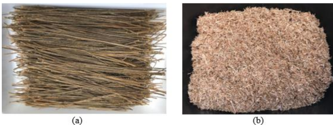
Figura 29 – a) Fibras longas tratadas e b) fibras curtas tratadas Fonte: Autor (2019)
