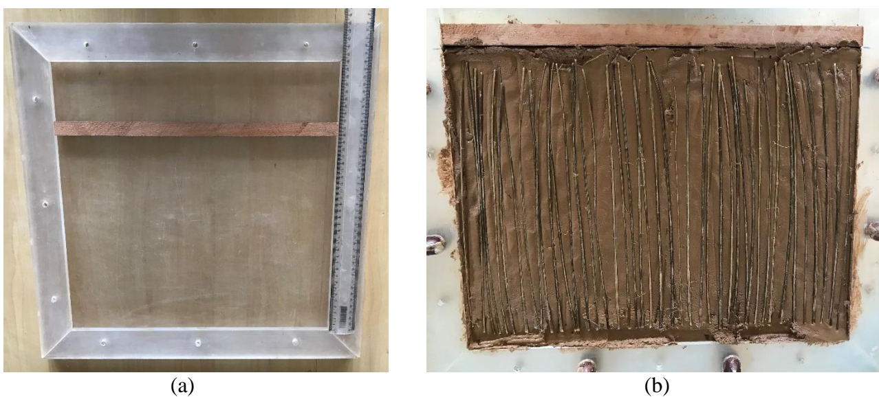
Figura 26. a) Molde do CFL; e b) produção do CFL Fonte: Autor (2019)
