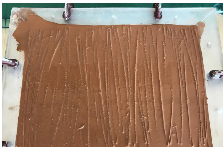
Figura 35 – Fibras longas na superfície da placa com matriz de fator a/c 0,45 e 2% de teor de superplastificante Fonte: Autor (2019)
