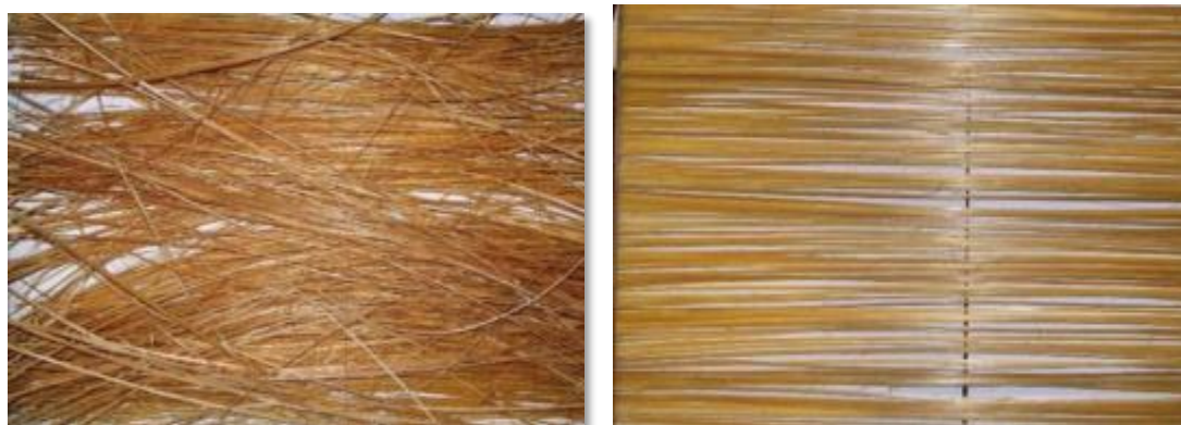
(a) (b) Figura 11 - (a) Fibra de bambu e (b) lâmina de bambu. Fonte: COSTA et al., 2007
