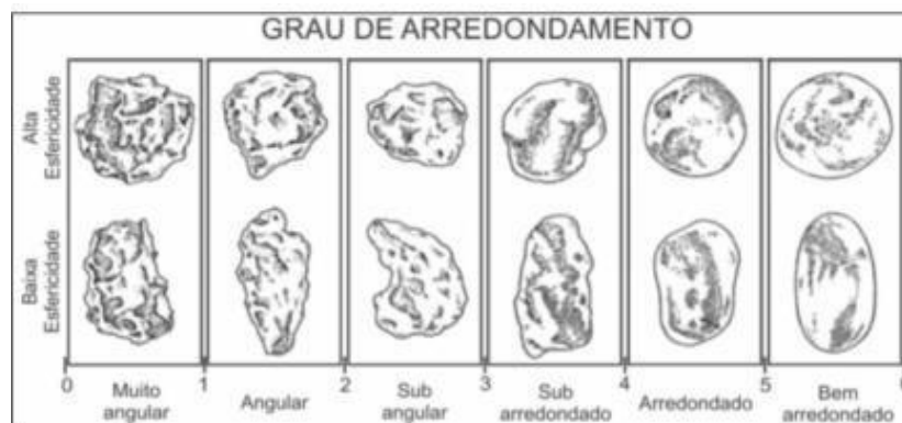
Figura 3 - Tabela do grau de arredondamento e esfericidade dos grãos, segundo Powers (1953).
